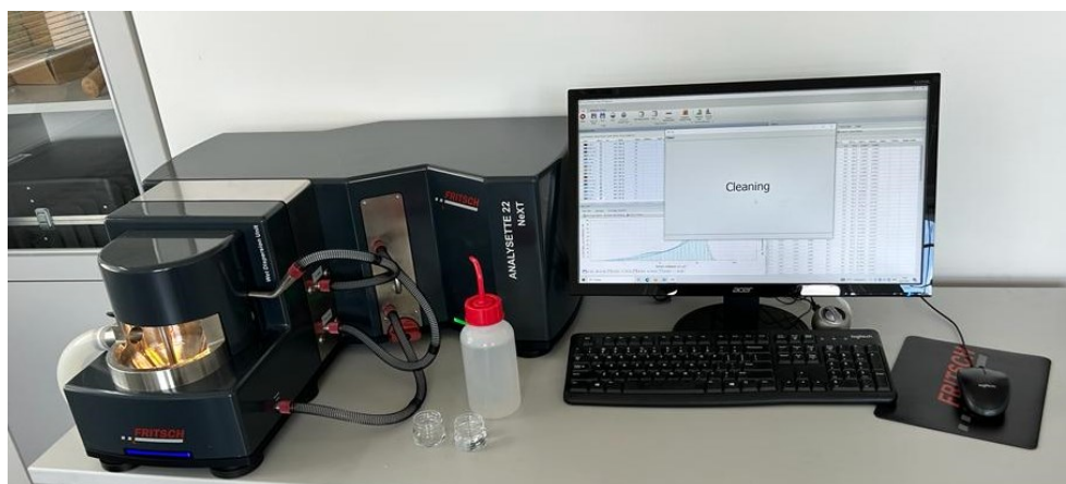
Obr. 35 Laserový difraktometr v pedologické laboratoři ústavu VHK
