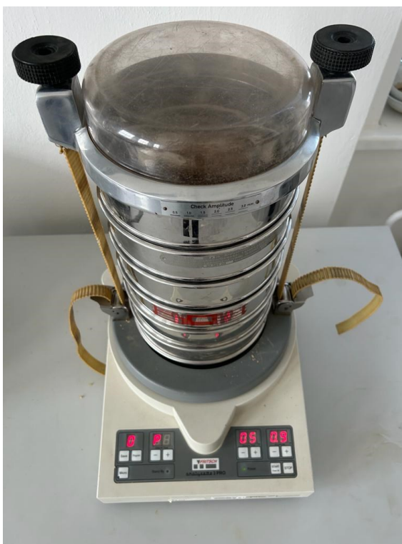
Obr. 23 Mechanická prosévačka s připraveným vzorkem
