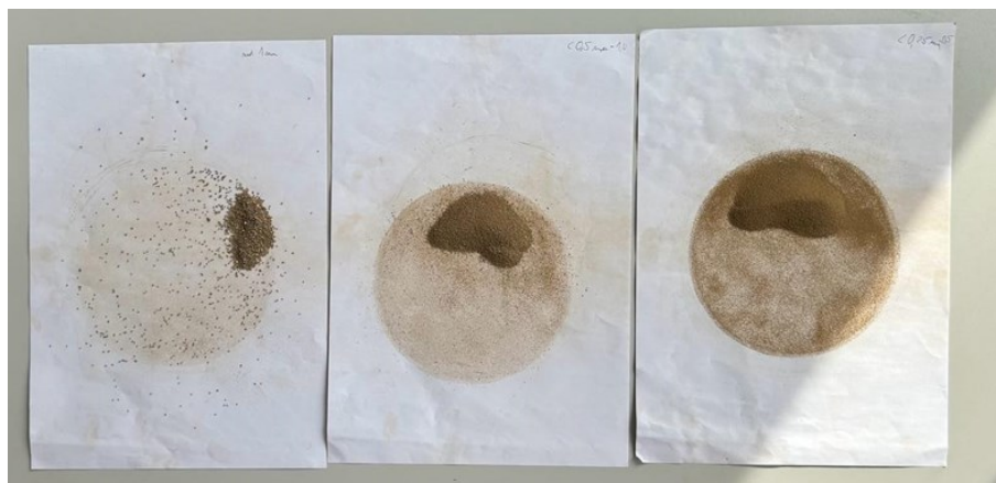
Obr. 24 Vzorek zeminy separován síty o velikosti oka 1, 0,5 a 0,25 mm
