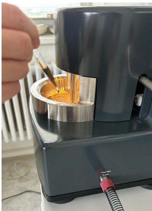
Obr. 38 Aplikace vzorku do dispergační jednotky laserového difraktometru
