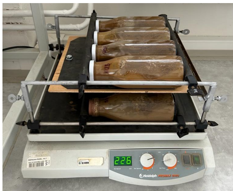
Obr. 27 Vzorčky zeminy ošetřené dispergačním činidlem a uložené do třepačky
