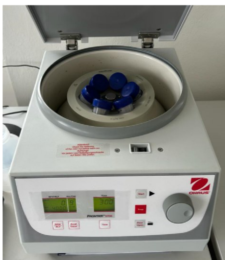
Obr. 37 Vzorky uložené do centrifugy
