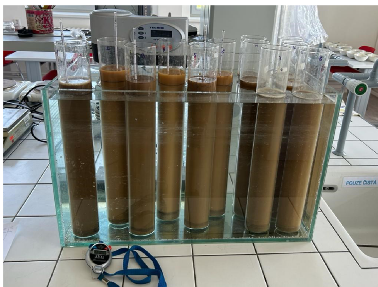
Obr. 28 Průběh hustoměrné zkoušky
