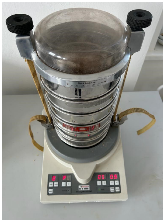
Obr. 23 Mechanická prosévačka s připraveným vzorkem
