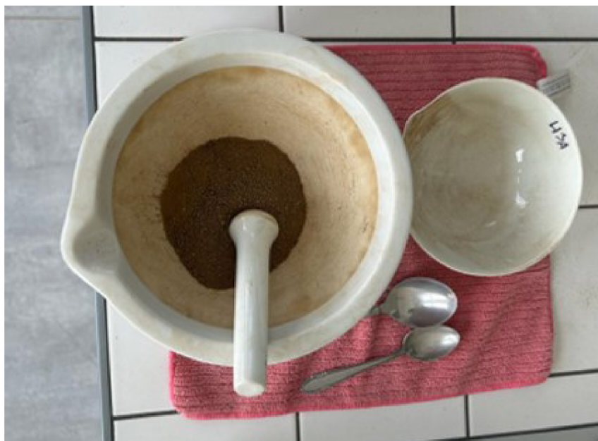
Obr. 22 Rozmělnění agregátů v třecí misce
