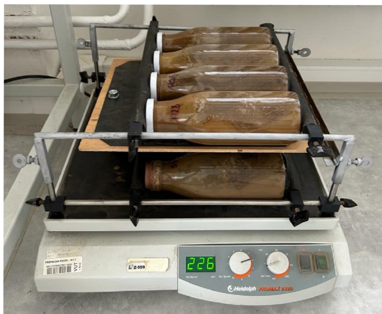
Obr. 27 Vzorky zeminy ošetřené dispergačním činidlem a uložené do třepačky
