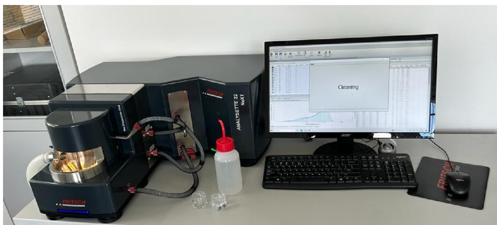
Obr. 35 Laserový difraktometr v pedologické laboratoři ústavu VHK
