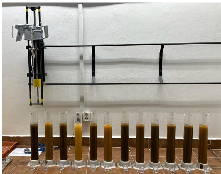
Obr. 32 Odměrné válce se suspenzí připravené k analýze
