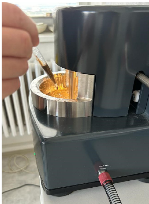
Obr. 38 Aplikace vzorku do dispergační jednotky laserového difraktometru
