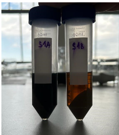
Obr. 36 Rozdíl v barvě roztoku mezi vzorkem z orniční a podorniční vrstvy po aplikaci KOH
