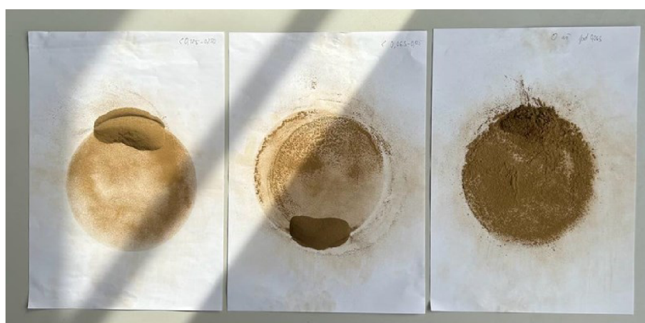
Obr. 25 Vzorek zeminy separován síty o velikosti oka 0,125, 0,063 a podsítný zbytek
