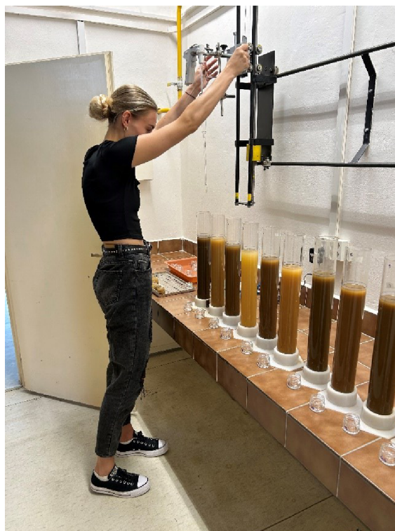
Obr. 33 Průběh měření při hustoměrné metodě
