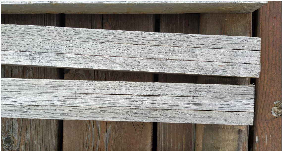
Obr. 4: Vzorky lepené polyuretanovým adhesivem PUR2010, neošetřené. (Zdroj: Autor práce)
