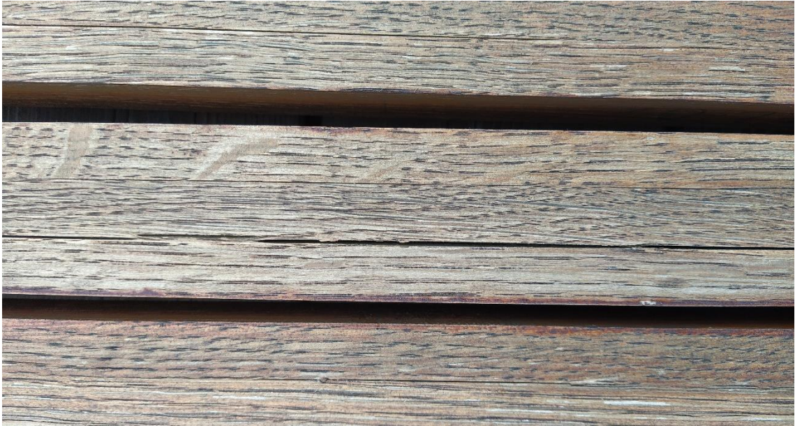
Obr. 3: Vzorky lepené polyuretanovým adhesivem PUR2010, neošetřené. (Zdroj: Autor práce)
