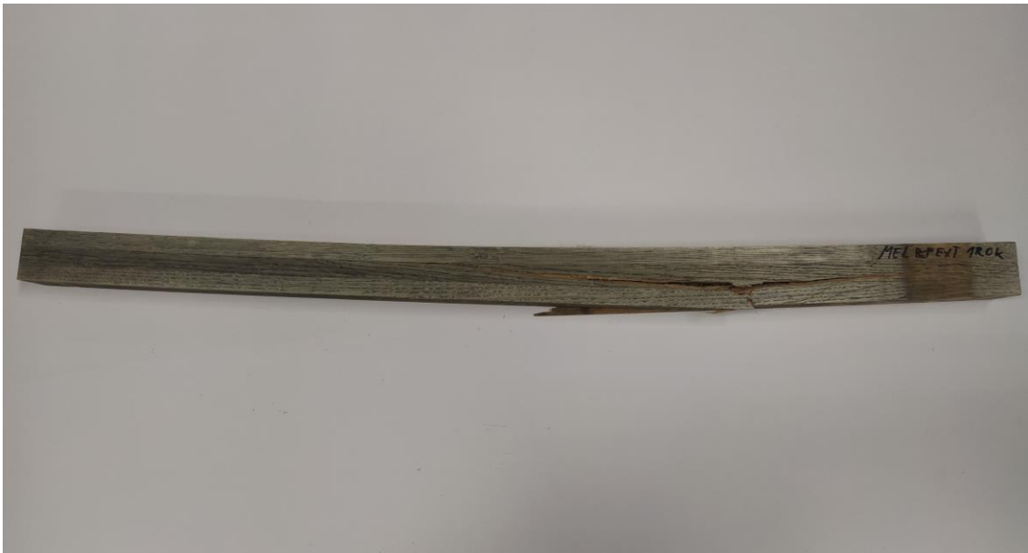
Obr. 7: Exponovaný vzorek lepený adhesivem GripPro Plus A011. (Zdroj: Autor práce)
