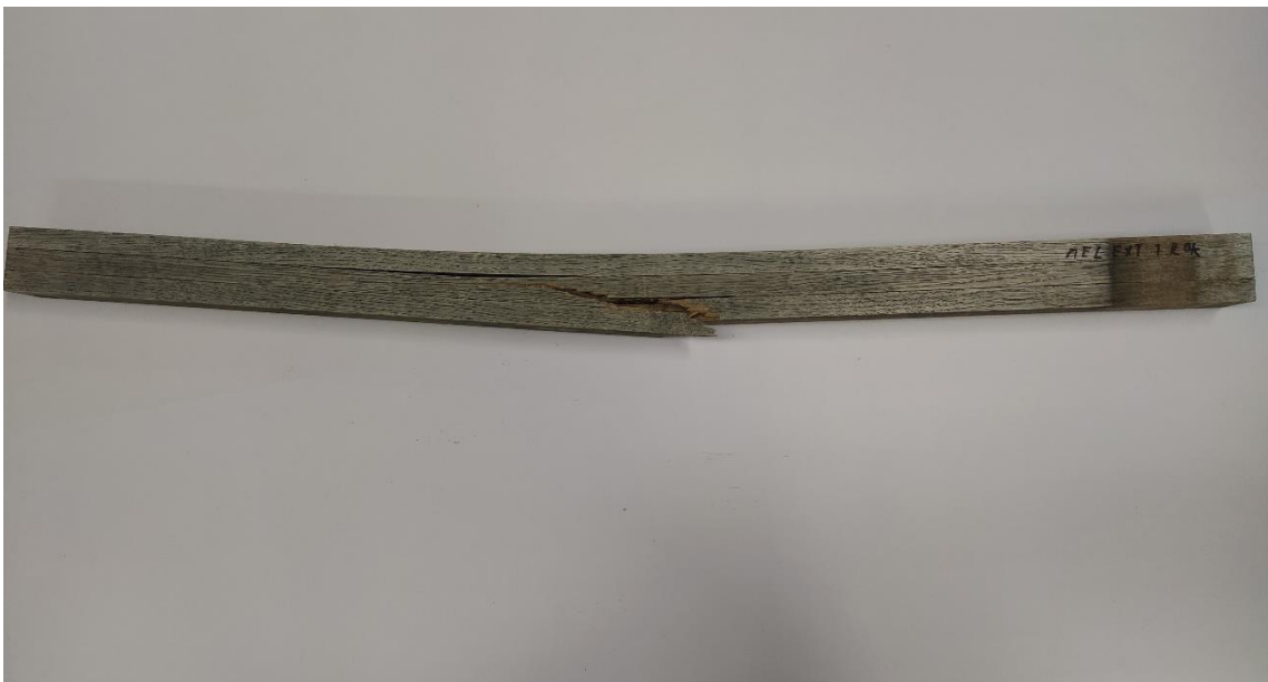
Obr. 8: Exponovaný vzorek lepený adhesivem GripPro Plus A011. (Zdroj: Autor práce)
