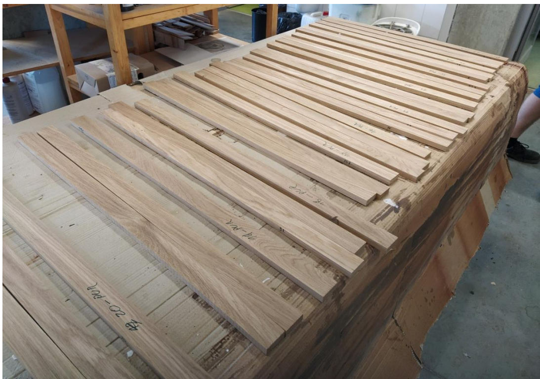
Obrázek 10: Připravené lamely před lepením zkušebních hranolů (Zdroj: Autor práce)
