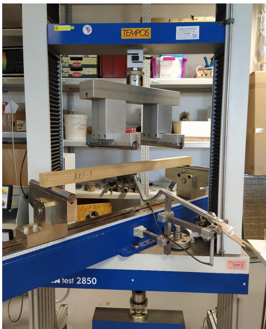
Obrázek 15: Uložení zkušebního hranolu do univerzálního trhačického stroje TIRA
