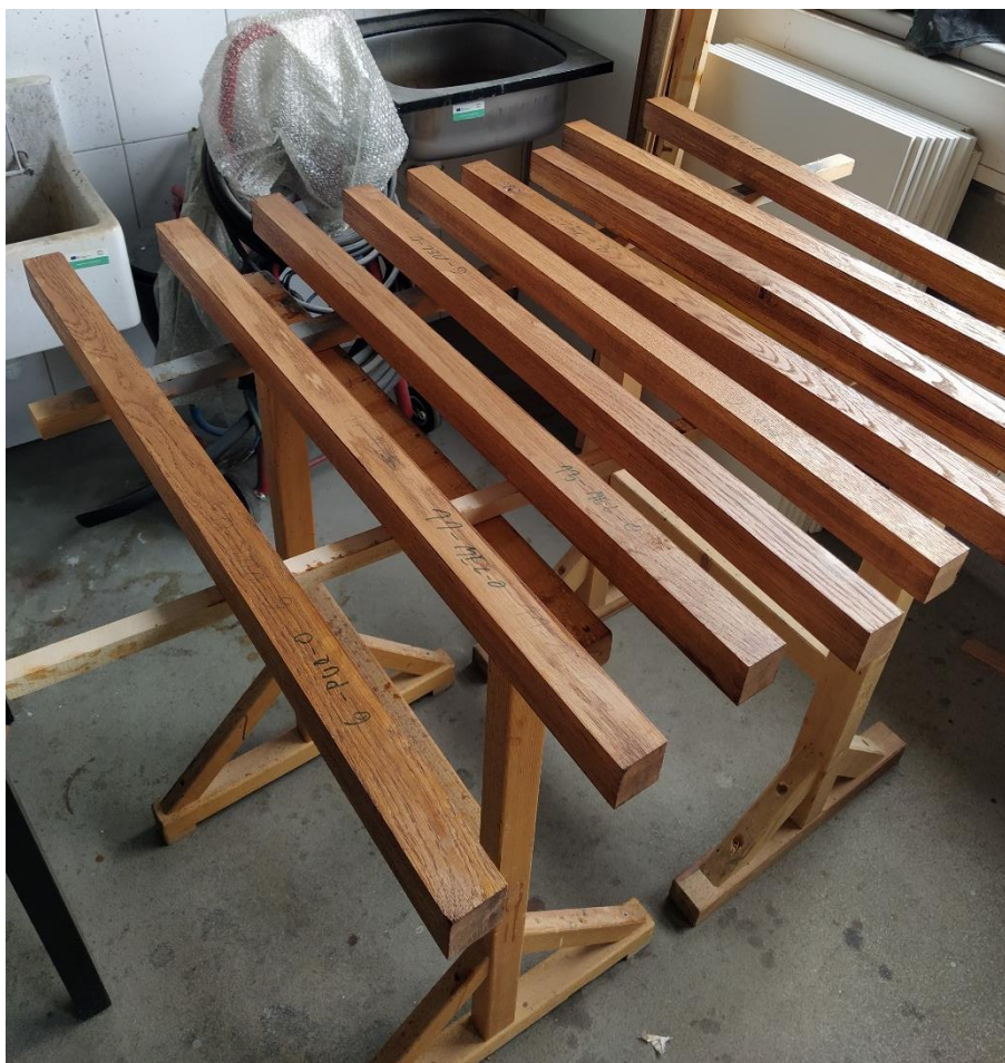
Obrázek 12: Natřené zkušební hranoly ochranou lazurou Xyladecor Terrace (Zdroj: Autor práce)
