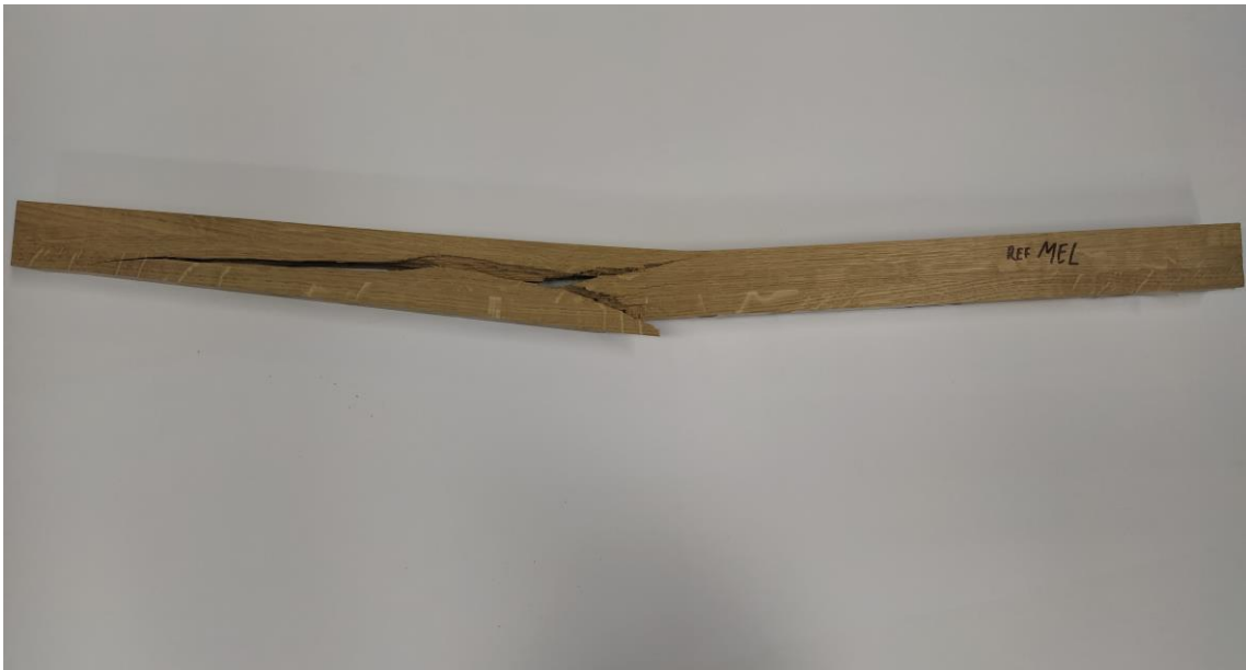
Obr. 3: Referenční vzorek lepený adhesivem GripPro Plus A011. (Zdroj: Autor práce)
