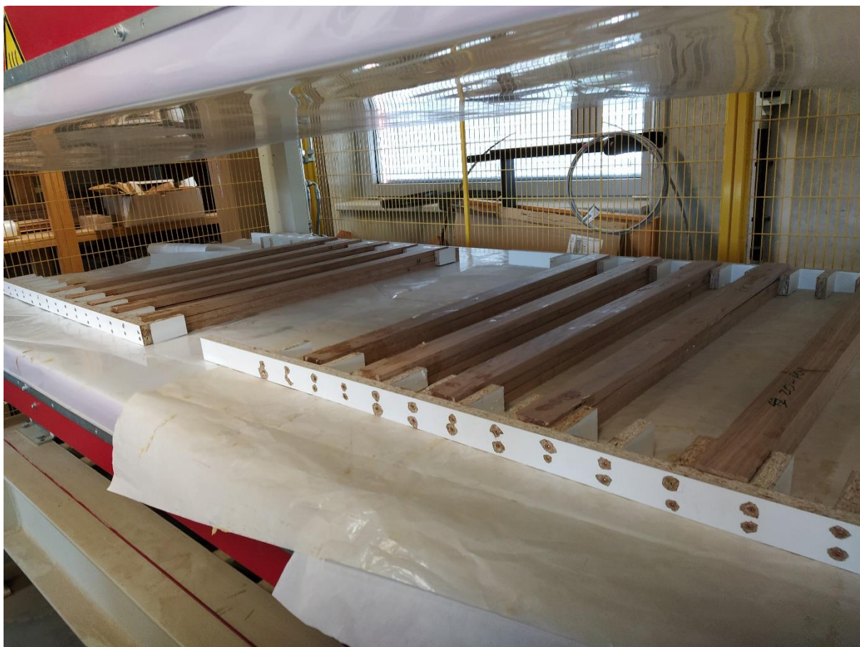
Obrázek 11: Naskládané lamely do hranolů ve speciálních přípravcích před spuštěním lisu (Zdroj: Autor práce)
