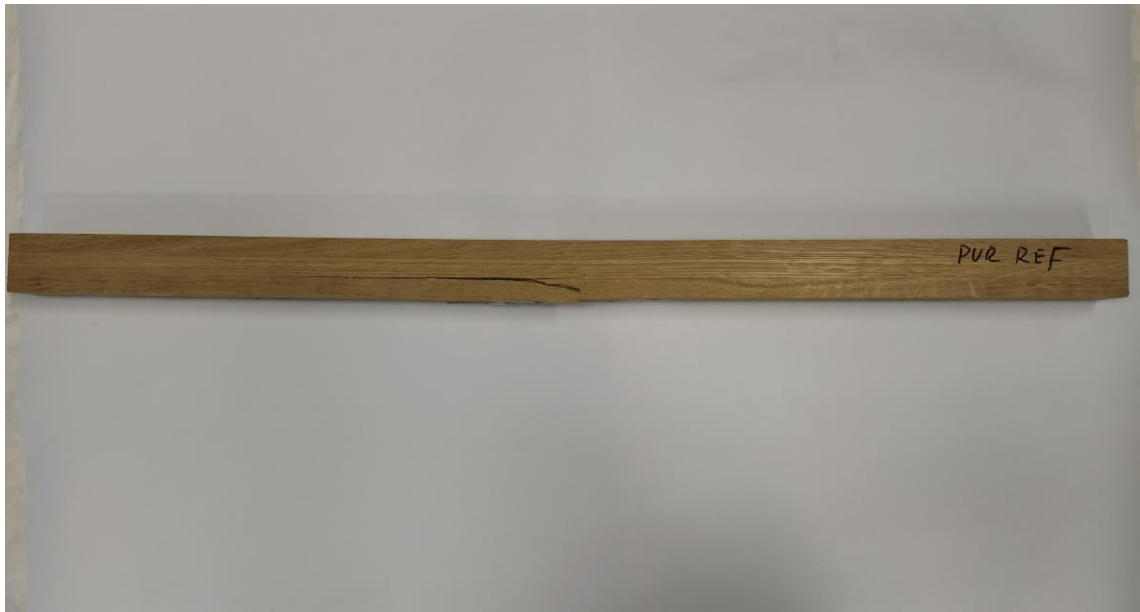
Obr. 5: Referenční vzorek lepený adhesivem PUR2010. (Zdroj: Autor práce)
