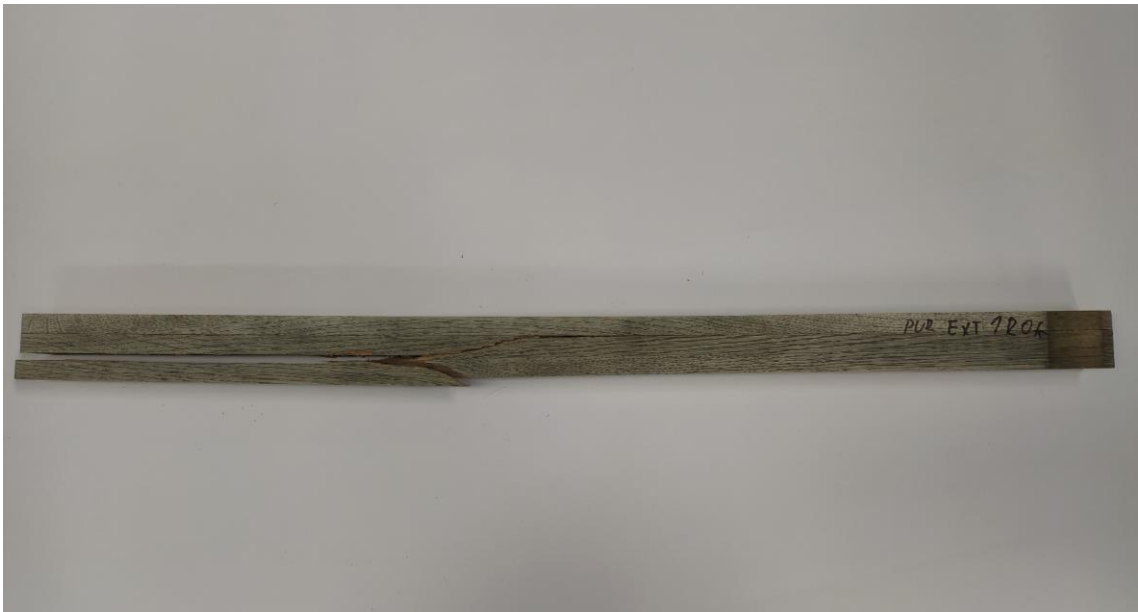
Obr. 9: Exponovaný vzorek lepený adhesivem PUR2010. (Zdroj: Autor práce)
