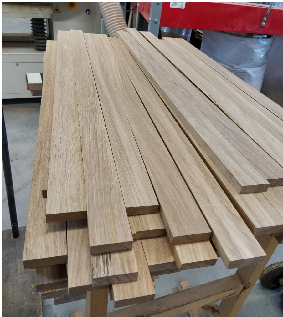
Obrázek 9: Zhotovené lamely pro výrobu zkušebních hranolů
