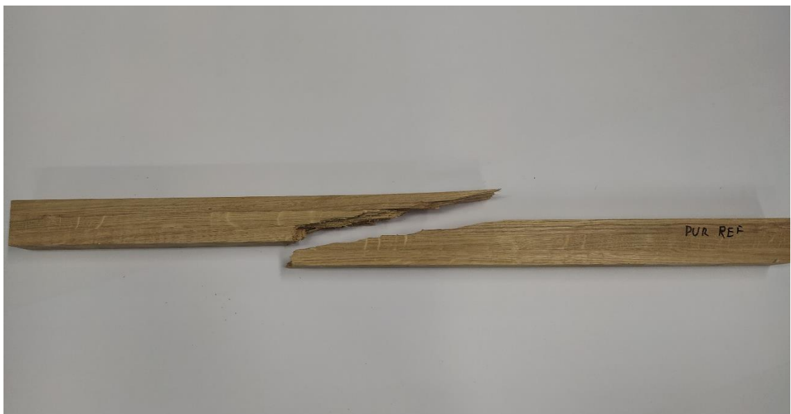
Obr. 6: Referenční vzorek lepený adhesivem PUR2010. (Zdroj: Autor práce)
