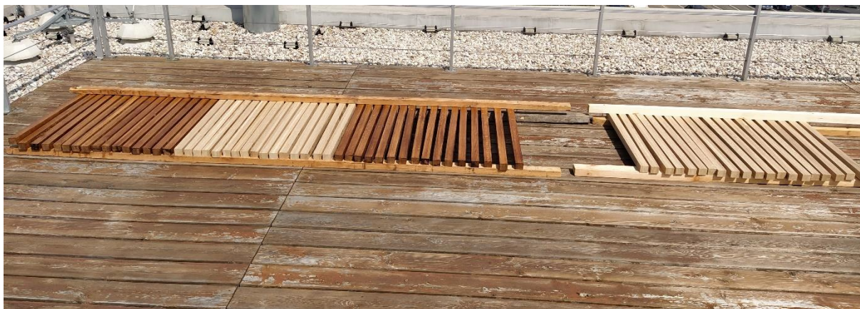
Obrázek 14: Exponované zkušební hranoly v exteriéru (Zdroj: Autor práce)
