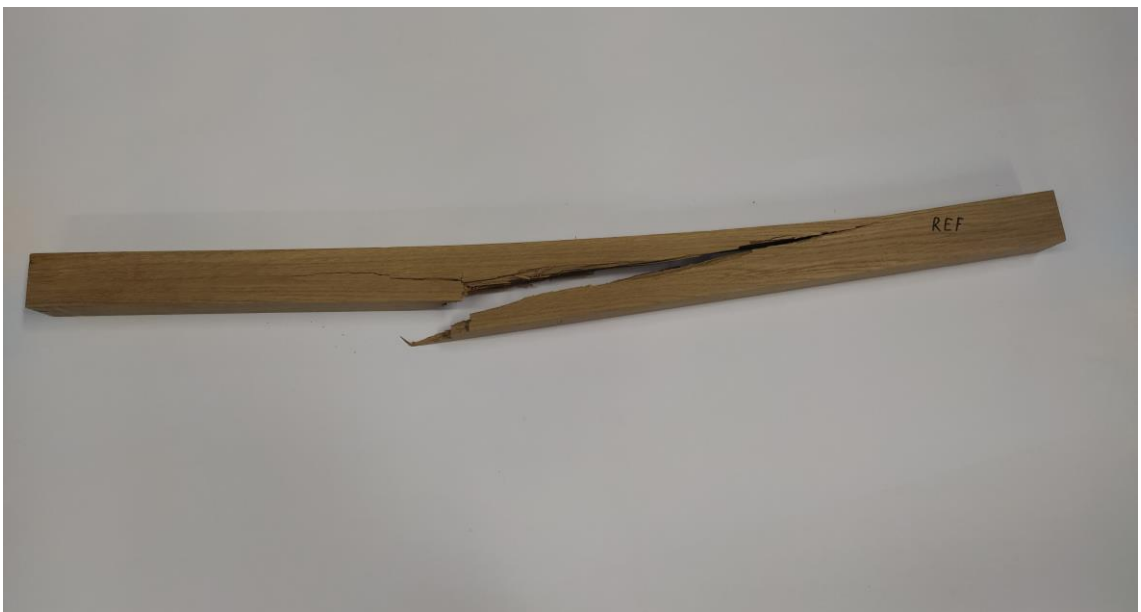
Obr. 2: Referenční vzorek masivního dubu. (Zdroj: Autor práce)
