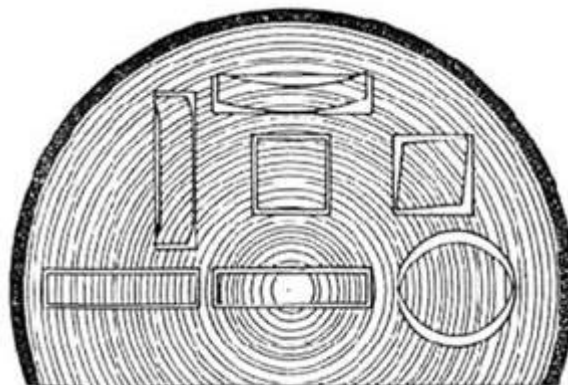
Obrázek 3: Znázornění příčného sesychání hranolů, desek a válců v různých polohách ve kmeni (Zdroj: Kolmann, Cote 1968)
