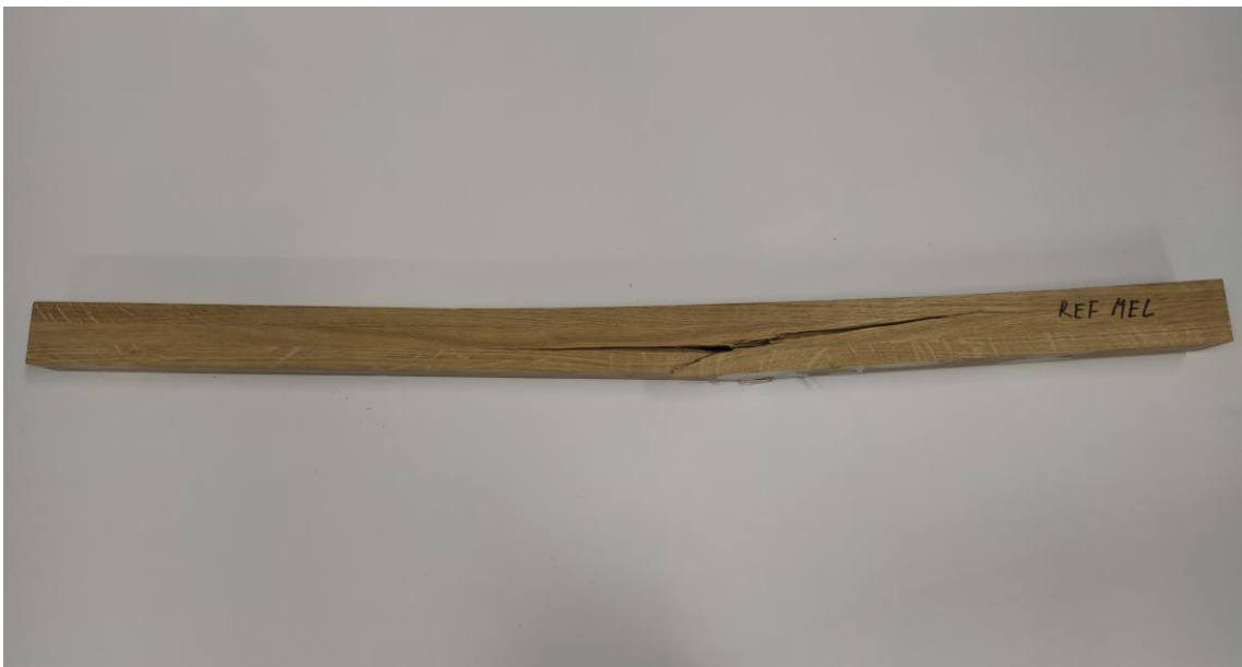
Obr. 4: Referenční vzorek lepený adhesivem GripPro Plus A011. (Zdroj: Autor práce)
