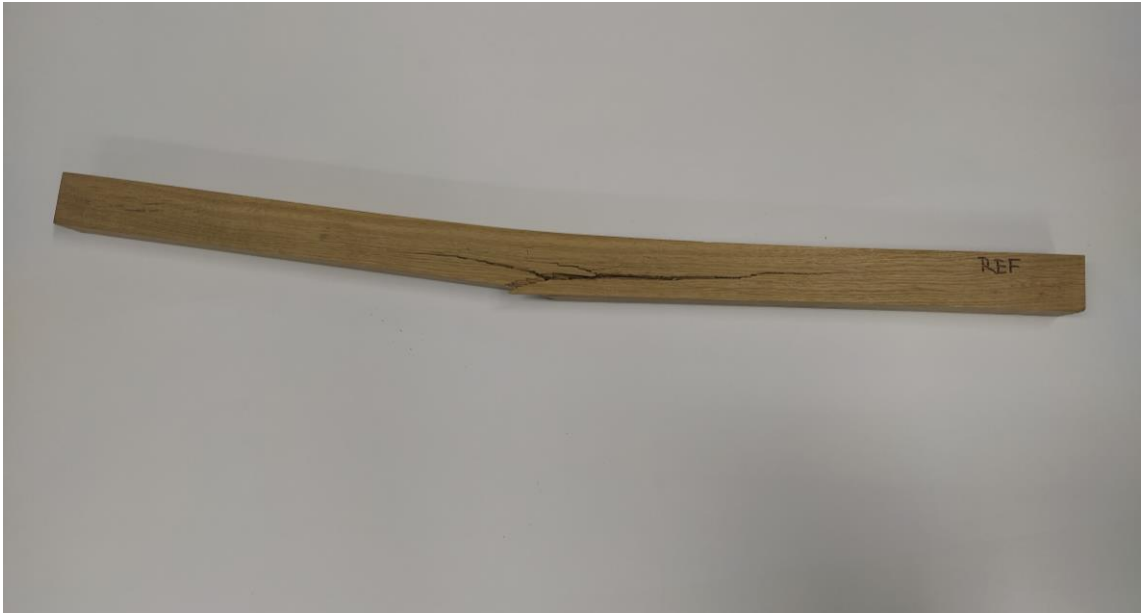
Obr. 1: Referenční vzorek masivního dubu. (Zdroj: Autor práce)
