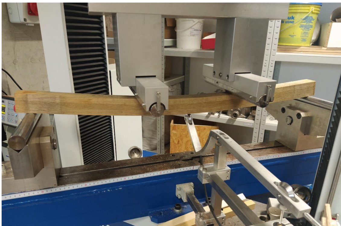
Obrázek 17: Průběh zkoušky pevnosti v ohybu a globálního modulu pružnosti v ohybu (Zdroj: Autor práce)
