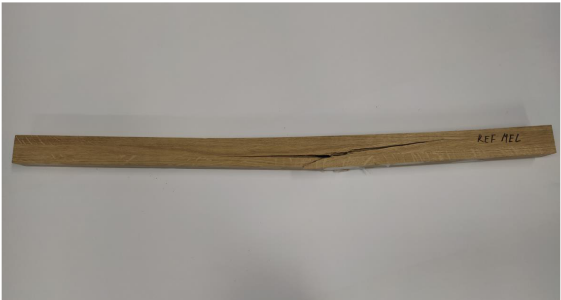
Obr. 4: Referenční vzorek lepený adhesivem GripPro Plus A011. (Zdroj: Autor práce)
