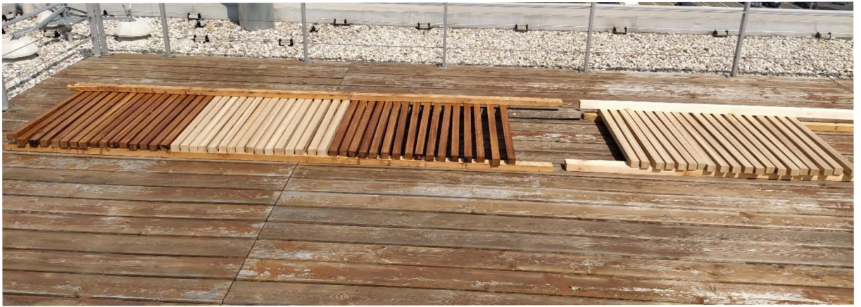
Obrázek 14: Exponované zkušební hranoly v exteriéru (Zdroj: Autor práce)
