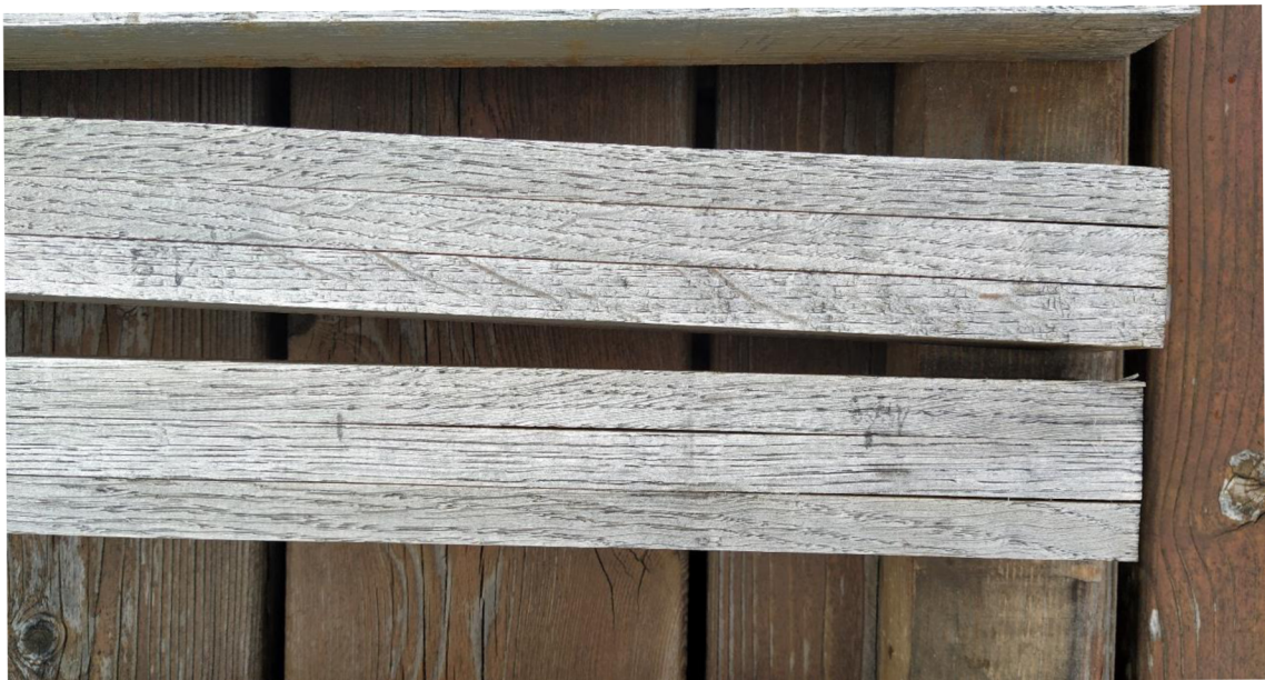
Obr. 4: Vzorky lepené polyuretanovým adhesivem PUR2010, neošetřené. (Zdroj: Autor práce)
