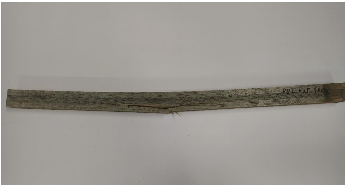
Obr. 10: Exponovaný vzorek lepený adhesivem PUR2010. (Zdroj: Autor práce)
