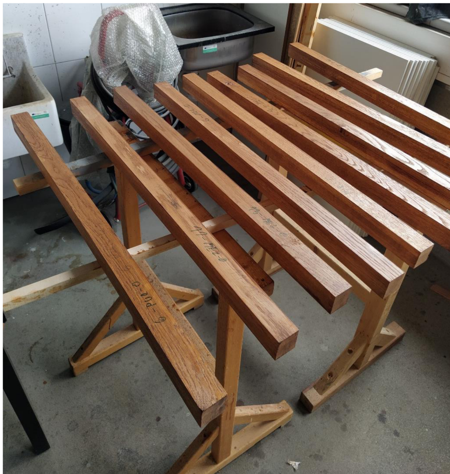
Obrázek 12: Natřené zkušební hranoly ochranou lazuroou Xyladecor Terrace (Zdroj: Autor práce)
