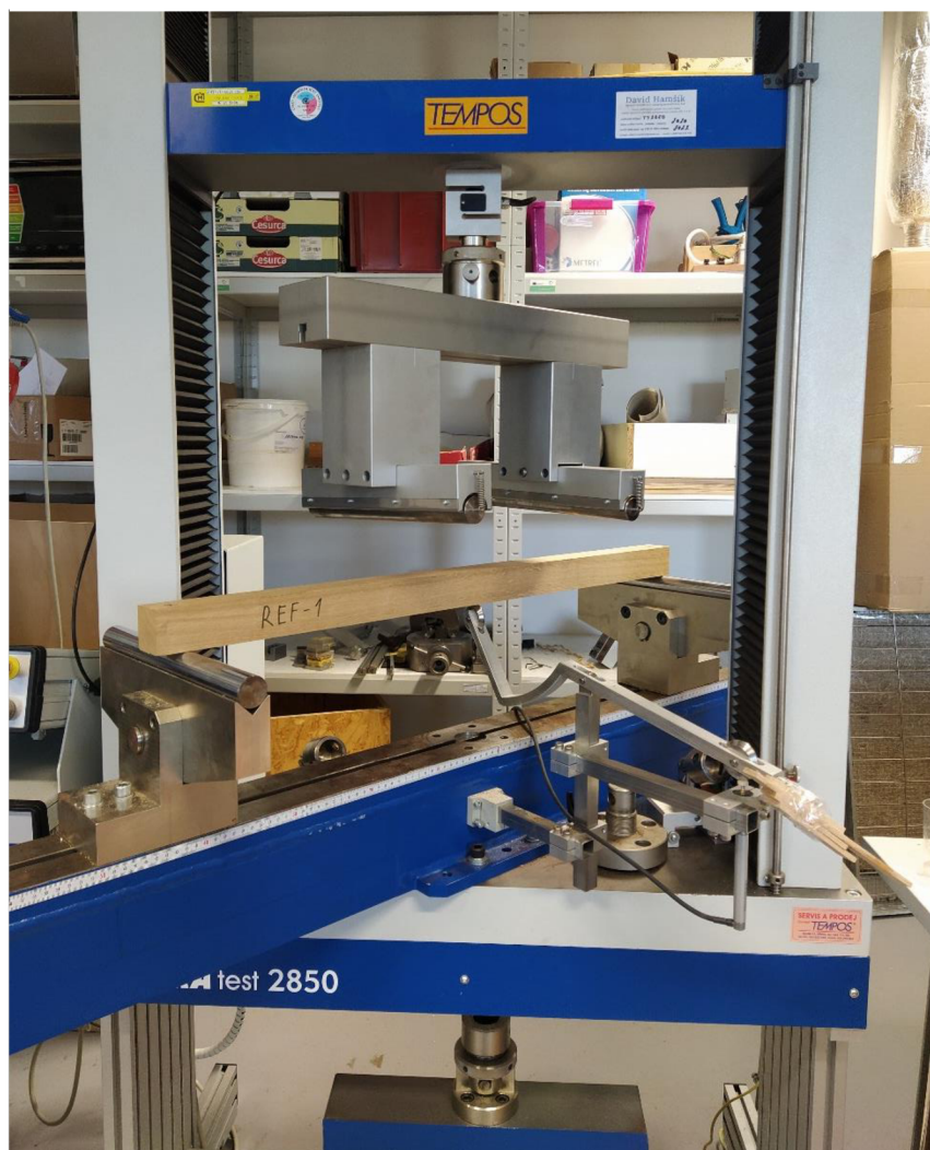
Obrázek 15: Uložení zkušební hranoly do univerzálního trhačího stroje TIRA
