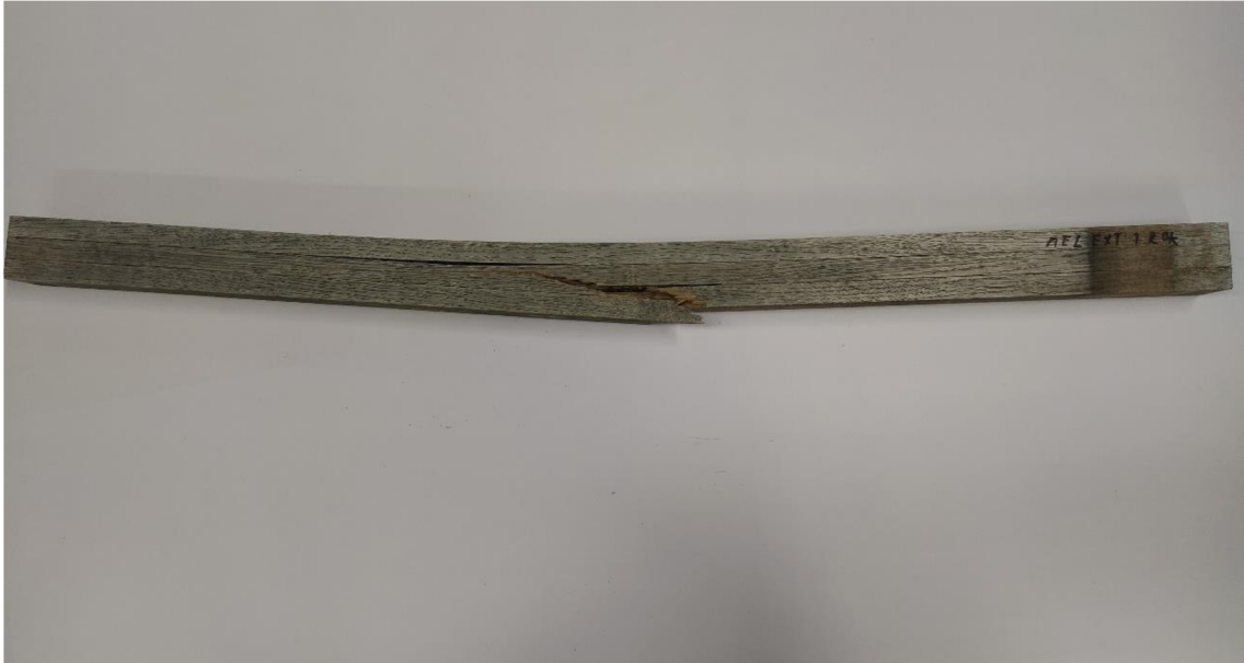
Obr. 8: Exponovaný vzorek lepený adhesivem GripPro Plus A011. (Zdroj: Autor práce)
