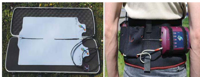
Obr. 6 Sedlová tenzometrická podložka pro měření tlaku na kontaktu těla jezdce a koně (Anonymous, n.d.)
