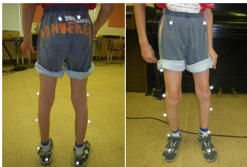
Obr. 8 Umístění a označení reflexních bodů dle modelu PlugInGait (vlastní foto, 2012)
