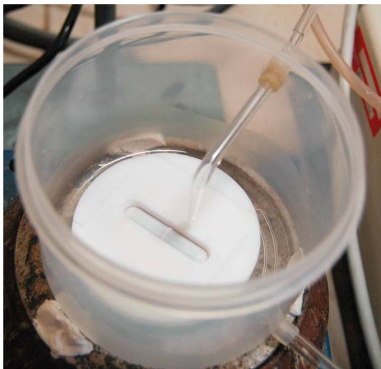
Obr. 19 Průtočný reaktor s rotačním držákem skla
