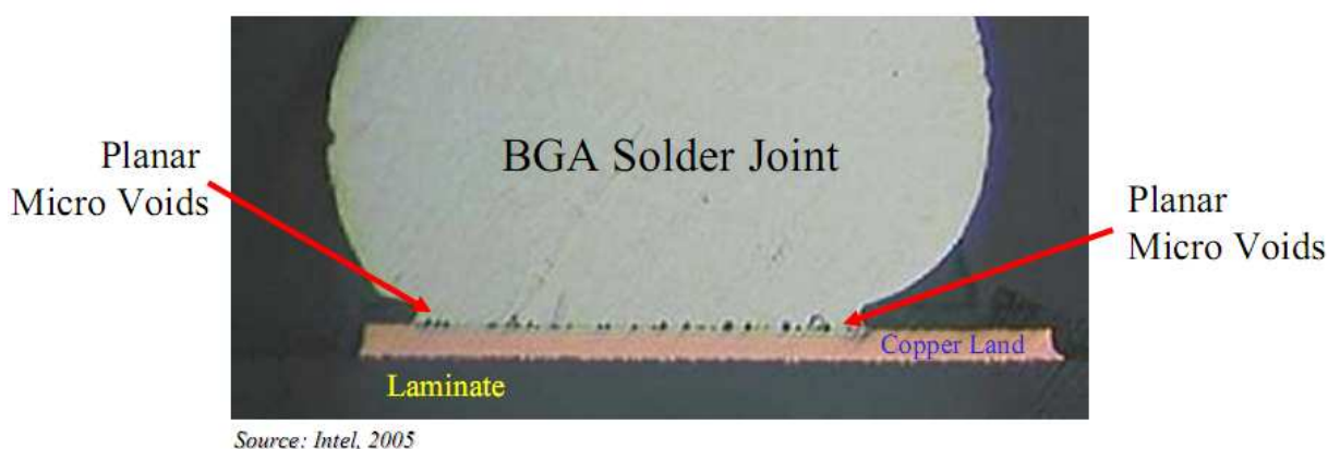
Obr 5: Micro voidy na rozhraní padu a pájky [6]
