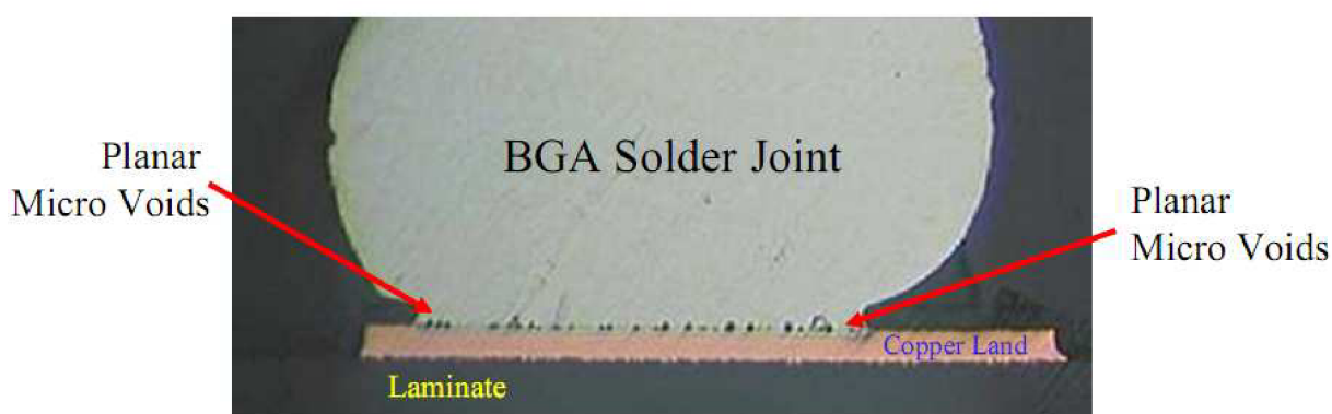
Obr 5: Micro voidy na rozhraní padu a pájky [6]
