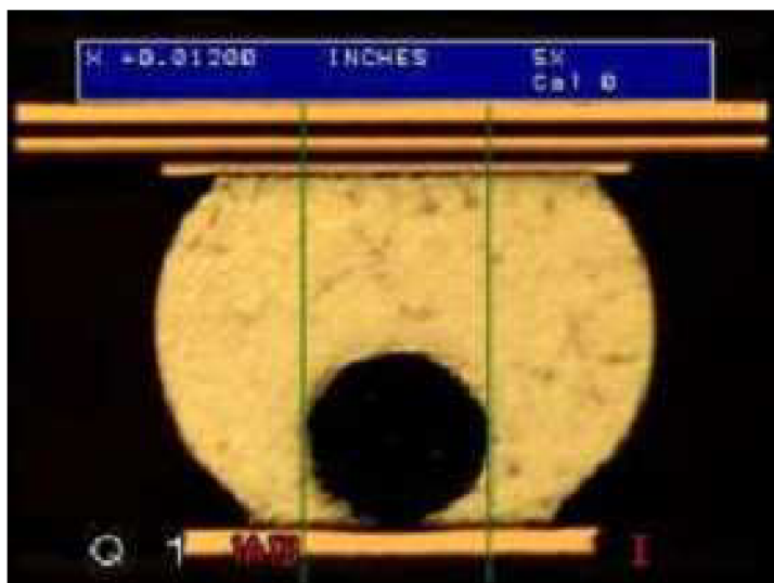
Obr 1: Snímek příčného řezu BGA spoje, který odhaluje přítomnost voidu ve spoji [6]
