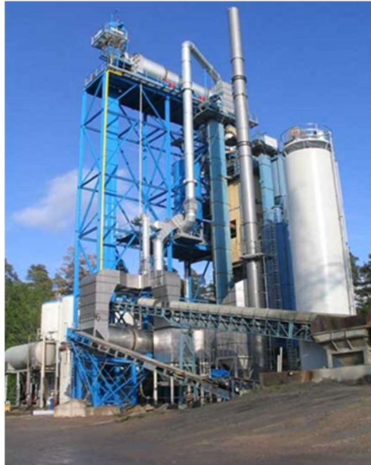
Obrázek 12: Obalovna s paralelním bubnem [15]
