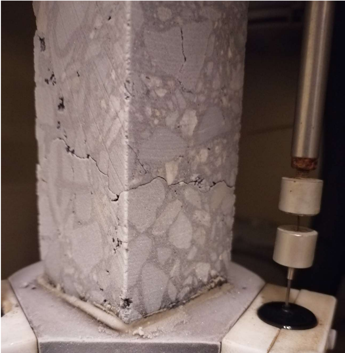
Obrázek 36: Tahová trhlina ve vzorku
