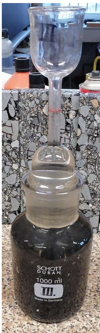
Obrázek 22: Pyknometr se zkušební vzorkem
