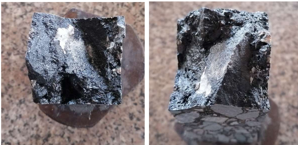
Obrázek 37: Lomová plocha porušeného vzorku
