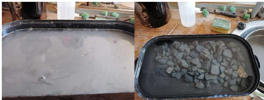
Obrázek 21: Zkušební vzorek před a po praní
