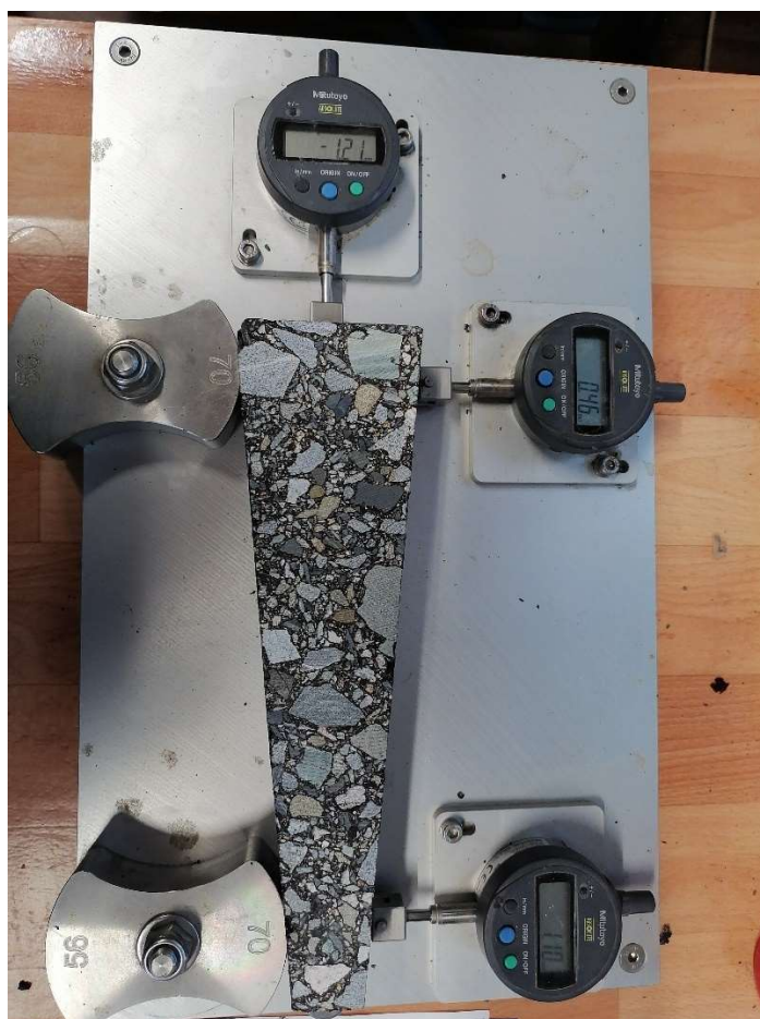
Obrázek 38: Meření přesných rozměrů komolých klínů
