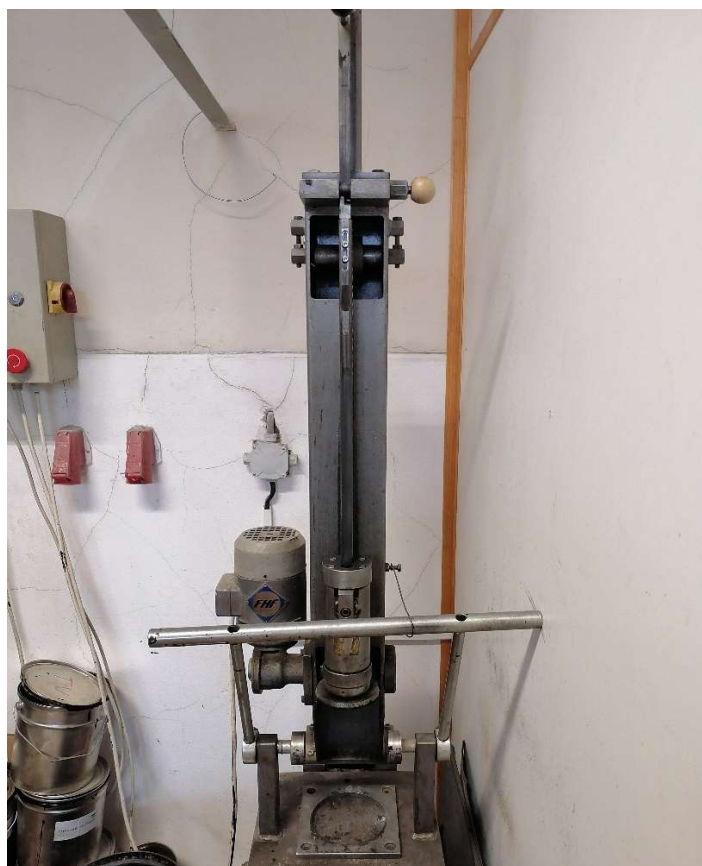
Obrázek 31: Hutnicí pěch na hutnění Marshallových těles
