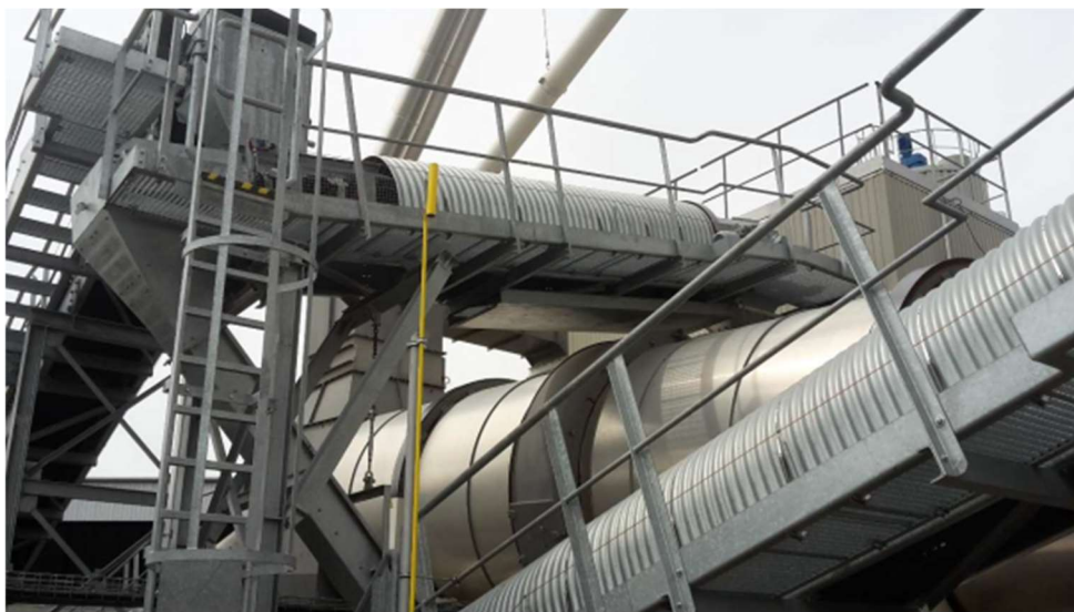
Obrázek 15: Šaržová obalovna s dvouplášťovým bubnem [14]
