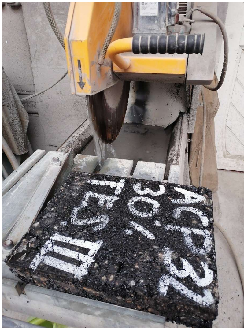
Obrázek 26: Výroba zkušebních vzorků řezáním
