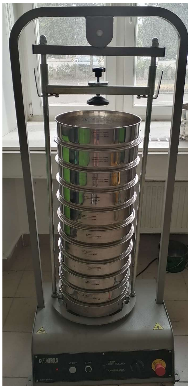
Obrázek 20: Sestava sít s automatickou vibrací
