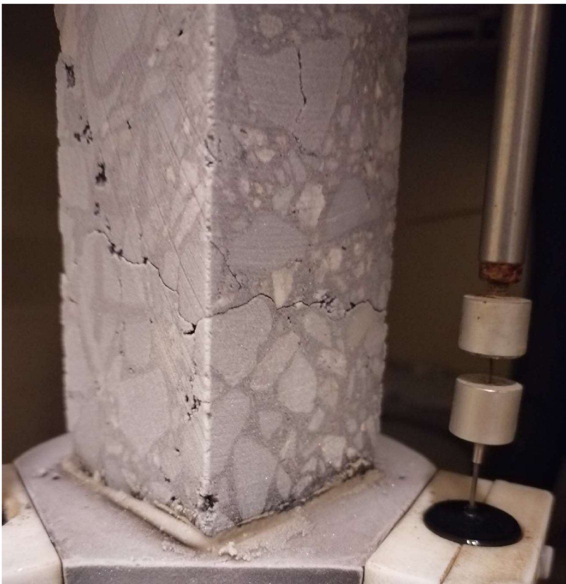
Obrázek 36: Tahová trhlina ve vzorku
