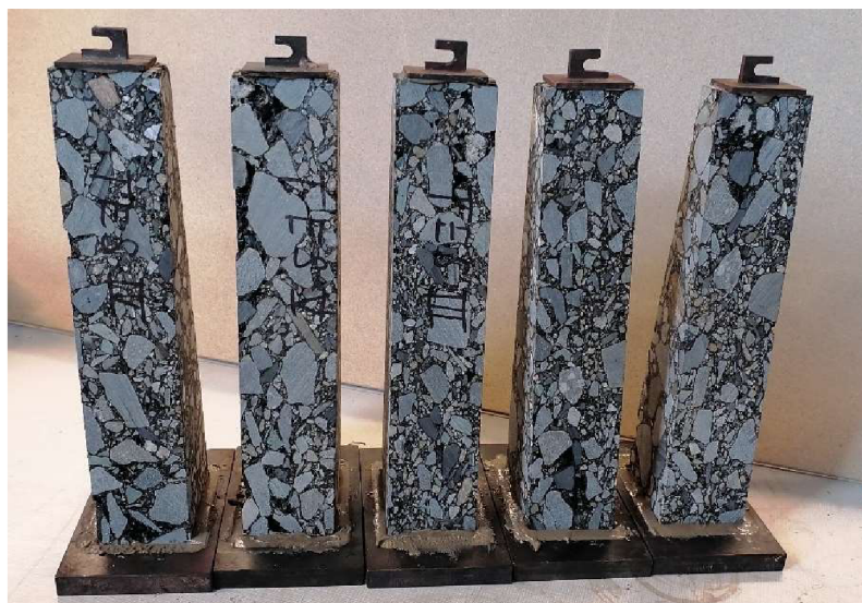
Obrázek 27: Zkušební tělesa pro stanovení tuhosti
