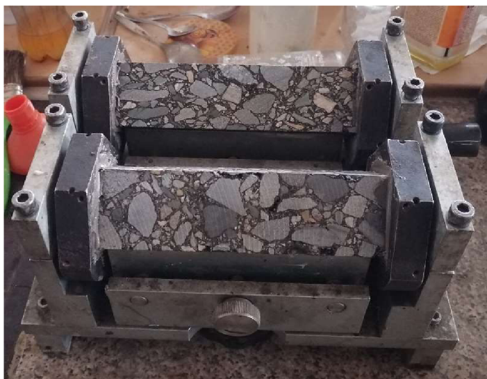
Obrázek 25: Zkušební vzorky v centrovacím rámu
