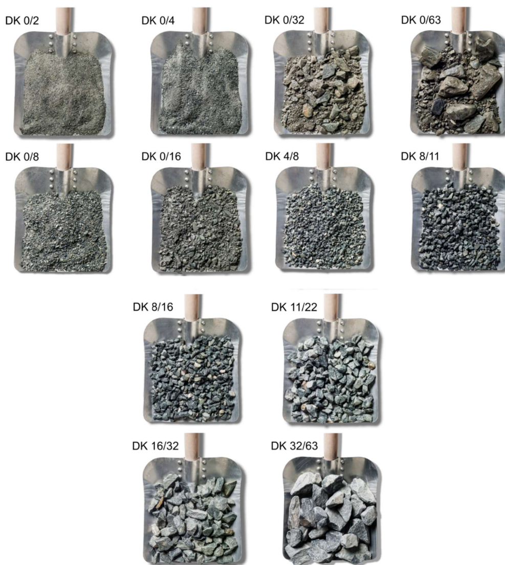
Obrázek 4: Běžně využívané frakce ve stavebnictví [8]
