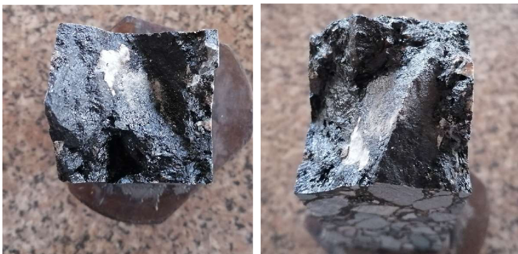
Obrázek 37: Lomová plocha porušeného vzorku
