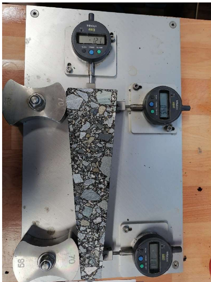
Obrázek 38: Meření přesných rozměrů komolých klínů
