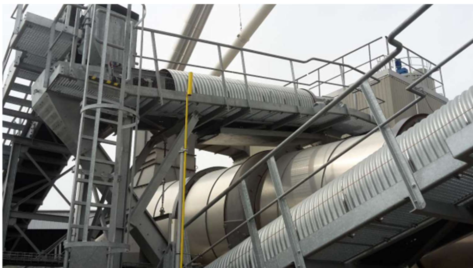
Obrázek 15: Šaržová obalovna s dvouplášťovým bubnem [14]
