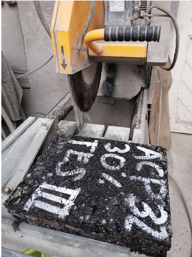
Obrázek 26: Výroba zkušebních vzorků řezáním
