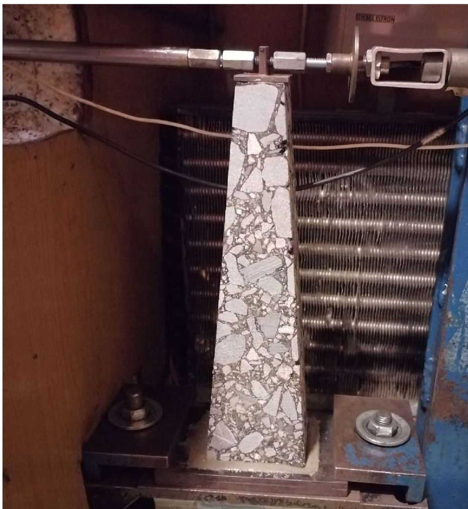
Obrázek 30: Zkušební vzorek tzv. trapezoid neboli komolý klín ve zkušebním přístroji
