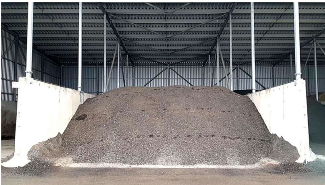
Obrázek 6: Skladování R-materiálu v zastřešené skládce [10]
