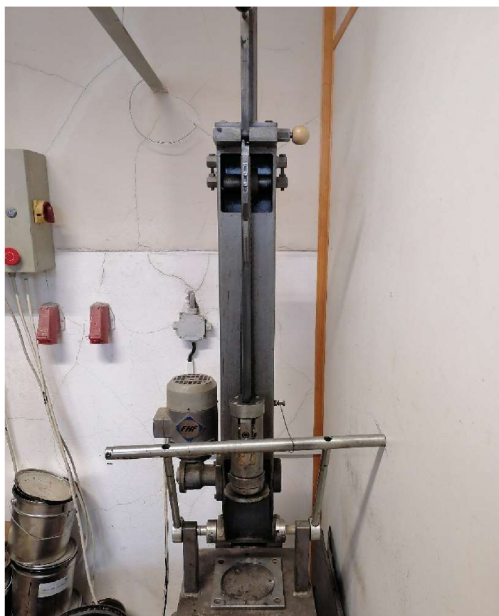
Obrázek 31: Hutnicí pěch na hutnění Marshallových těles
