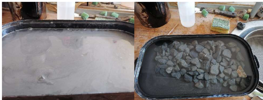
Obrázek 21: Zkušební vzorek před a po praní
