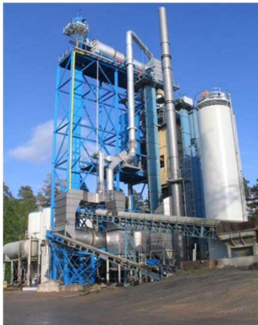
Obrázek 12: Obalovna s paralelním bubnem [15]
