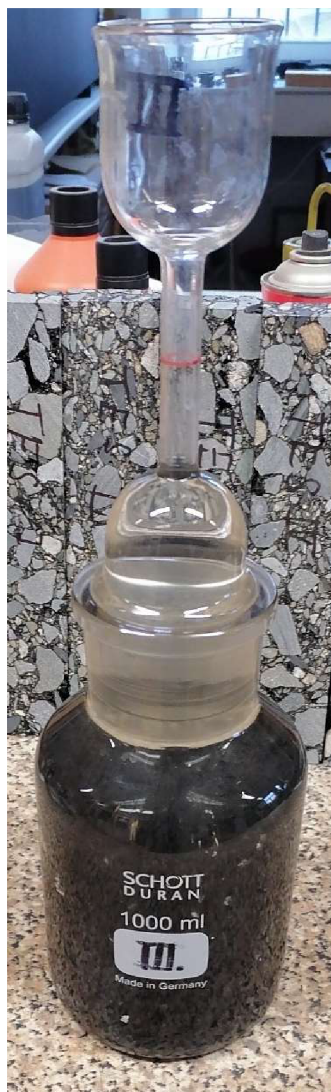
Obrázek 22: Pyknometr se zkušebním vzorkem
