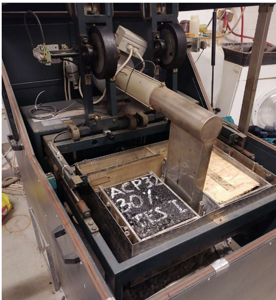
Obrázek 23: Malé zkušební zařízení pro zkoušku pojíždění kolem
