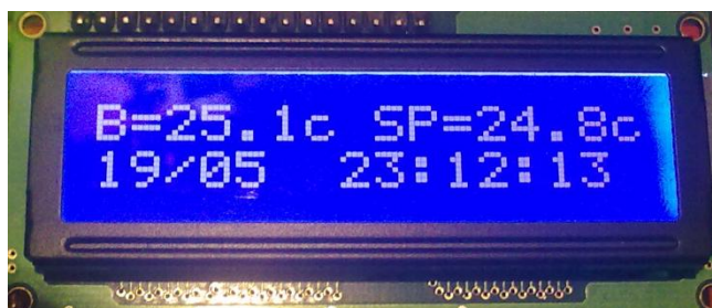
Obr. 18 LCD displej 16x2 s modrým podsvětlením.
