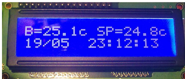
Obr. 18 LCD displej 16x2 s modrým podsvětlením.
