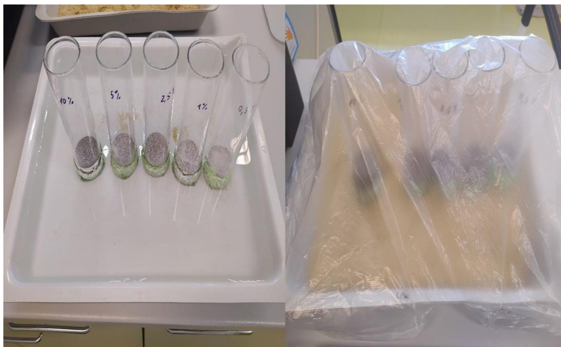
Obr. 6. Stanovenie maximálnej vodnej kapacity zmesi (zdroj: vlastný)
