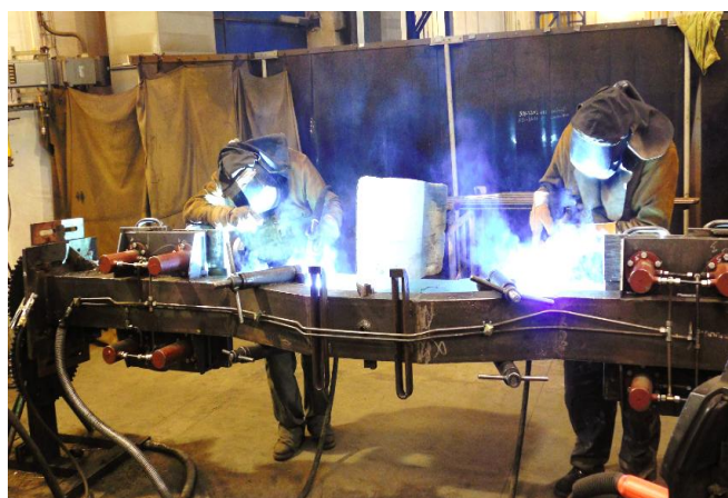
Obr. č. 30: pracoviště svařování podélníku Y 25
