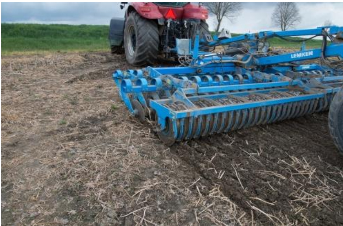
Obrázek 8: Zpracování půdy bez obracení – kypřič půdy (Encyklopedie VÚMOP ©2021)
