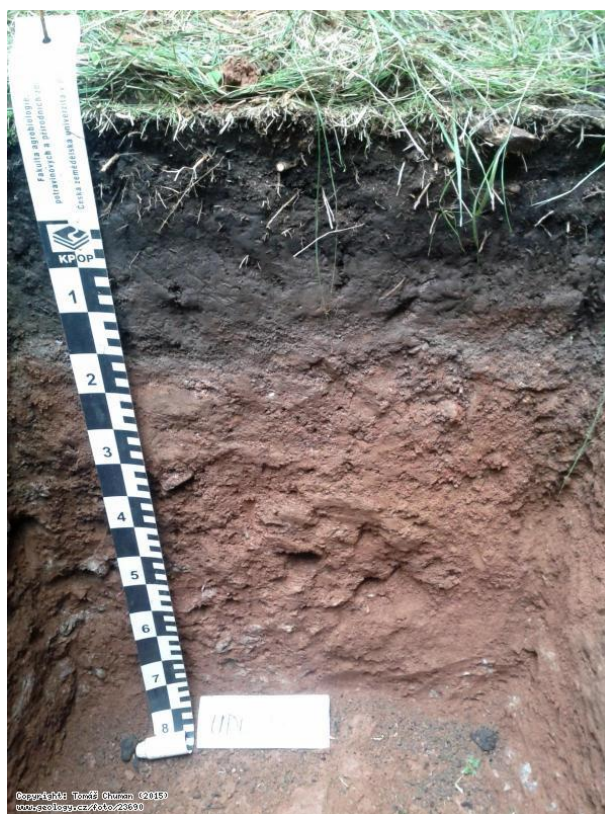
Obrázek 16: Ukázka půdní sondy (Česká geologická služba, ©2021)
