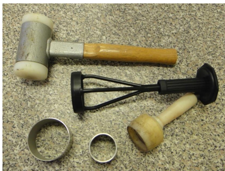
Obrázek 15: Sada k odběru půdních vzorků včetně Kopeckého válečku (Česká geologická služba, ©2021)
