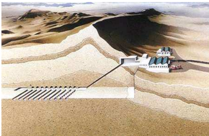
Obr. č. 4: Vstup a schéma úložiště v Yucca Mountains, USA (Zdroj: SURAO)
