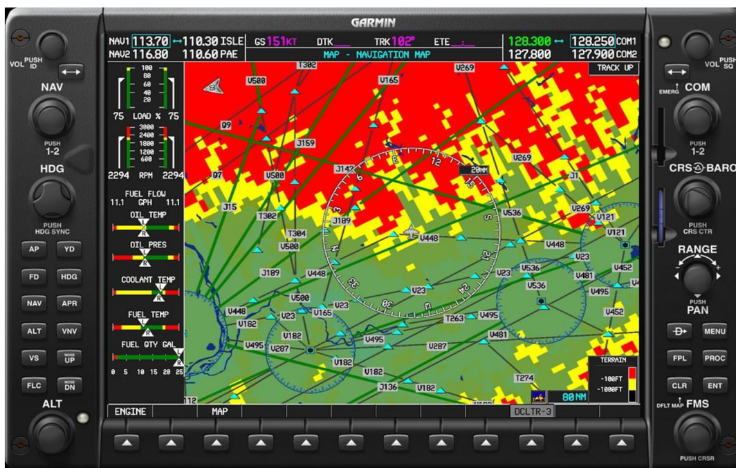
Obr. 18 Multifunkčný displej so znázornením výškových hladín od firmy GARMIN [31]
