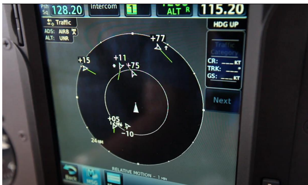
Obr. 19 Znážornenie leteckej premávky na displeji v kokpíte od firmy GARMIN [31]
