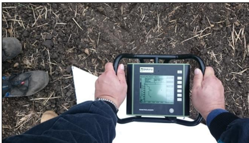
Obr. 34 Displej penetrometru (foto autor)
