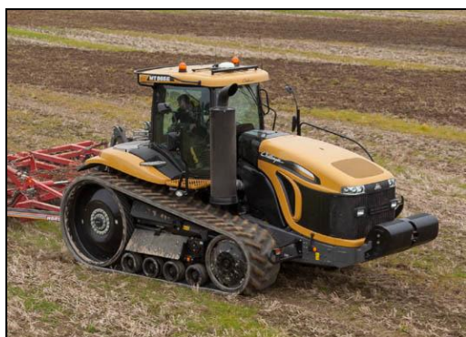
Obr. 17 Traktor se dvěma pásy ( www.challenger-ag.com )
