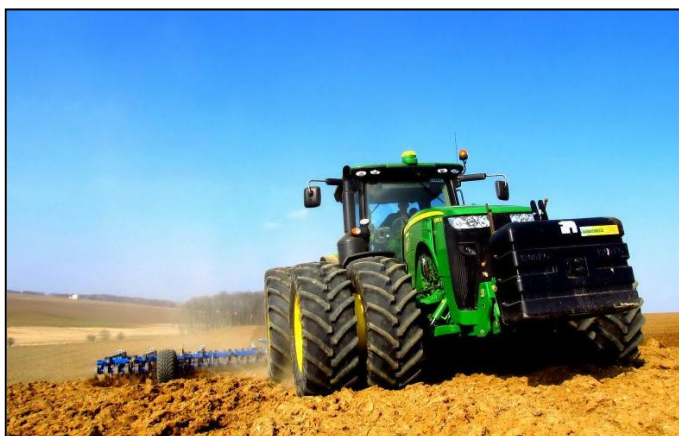
Obr. 16 Traktor John Deere osazený dvoumontáží při strhávání hrubé brázdy ( www.farmweb.cz )
