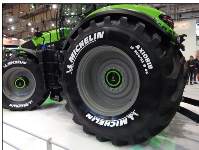
Obr. 11 Radiální, nízkotlaká traktorová pneumatika konstrukce IF o šířce 900 mm a průměru ráfku 46" (foto autor)
