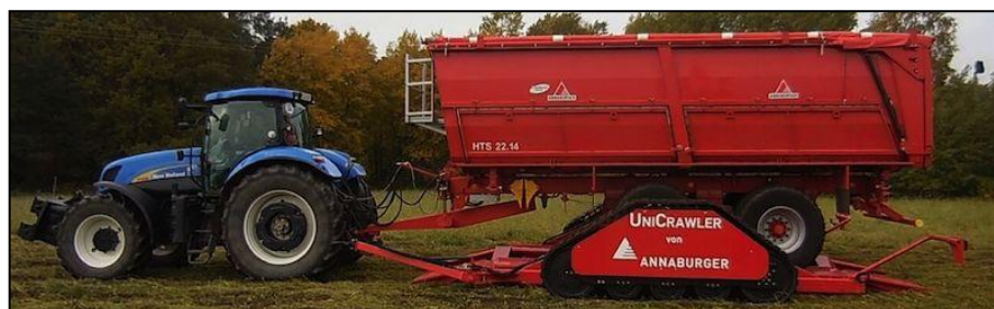
Obr. 27 Zabrzděný návěs na plošině UniCrawler (www.topagrar.pl)
