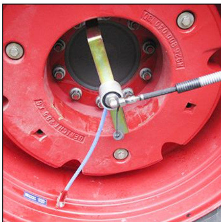
Obr. 14 Jedno-okruhový systém CTIS ( www.ptg.info )
