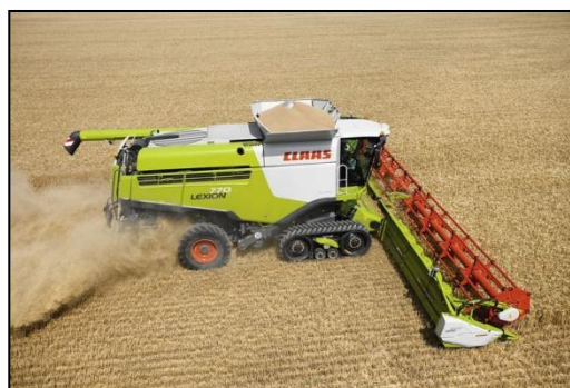
Obr. 20 Sklízecí mlátička s polo-pásovým podvozkem ( www.agrall.cz )
