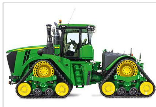
Obr. 18 Traktor se čtyřmi pásovými jednotkami ( www.deere.co.uk )
