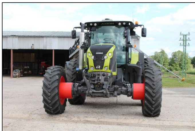
Obr. 23 Traktor osazený speciálními diskami ke zvýšení rozchodu kol ( www.grainews.ca )
