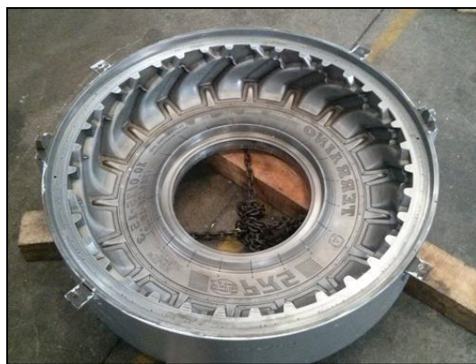
Obr. 7 Forma na výrobu pneumatiky ( www.indiamart.com )
