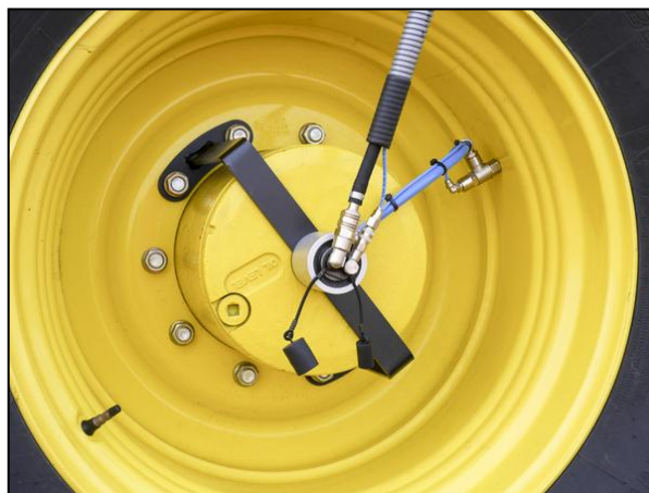
Obr. 15 Dvou-okruhový systém CTIS ( www.rbmagricultural.co.uk )
