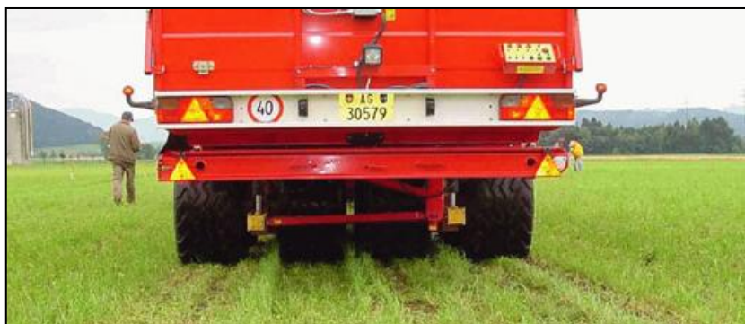
Obr. 22 Speciální osmi-kolový podvozek firmy Pöttinger (www.poettinger.at)
