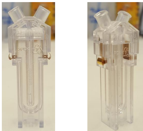
Obrázek 12: Speciální kyveta pro měření zeta potenciálu vodné disperze nanočástic.
