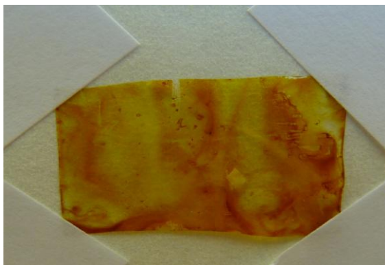
Obrázek 13: Nanesená vrstva koloidu stříbra s želatinou na celofánu.
