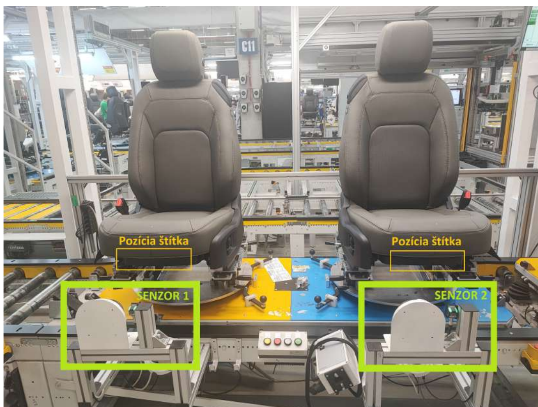
Obr. 5.1: Výsledná realizácia stanice
