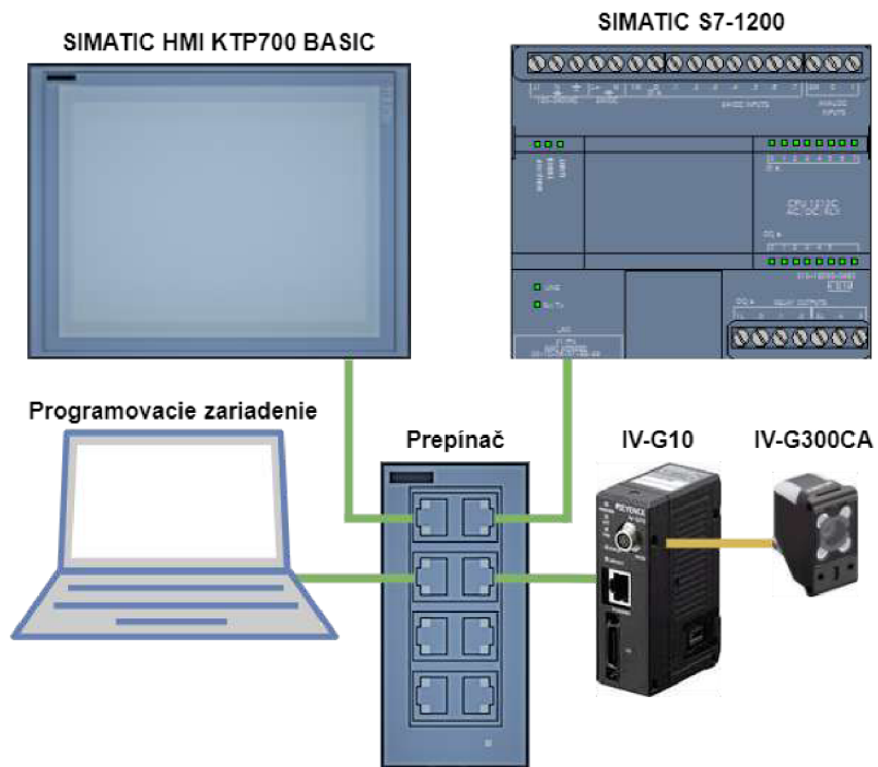
Obr. 3.4: Grafické schéma zapojenia testovacieho pracoviska
