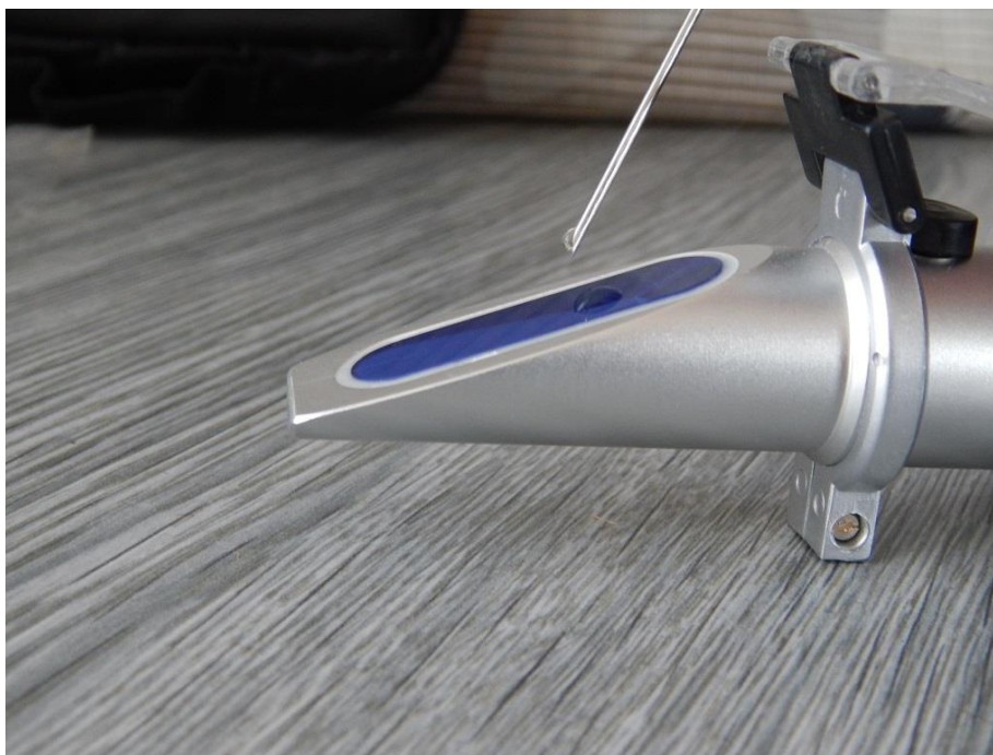
Obrázek 6: Nanesení krevního séra (1 až 2 kapky) na plochu optického refraktometru
