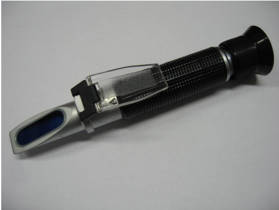
Obrázek 1: Ruční optický univerzální refraktometr s rozsahem měření 0 až 32 % Brix
