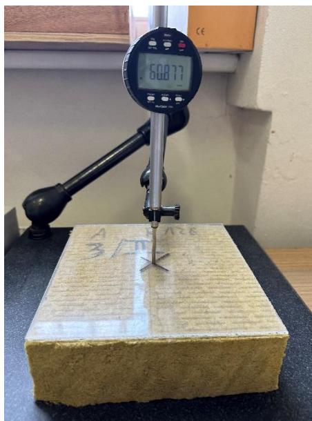
Obr. č. 26 - Měření tloušťky d pomocí číselníkového úchylkoměru
