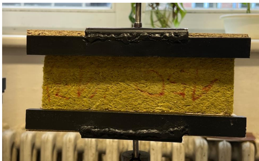
Obr. č. 27 - Upevnění zkušební vzorku do zkušební lisu pro stanovení pevnosti v tahu
