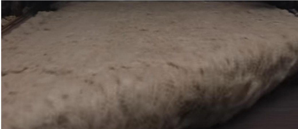
Obr. č. 5 – Doprava minerální vlny z usazovacího bubnu [61]
