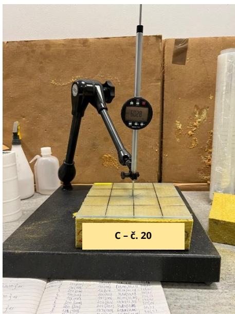
Obr. č. 19 – Měření tloušťky d na pomoci číselníkového úchylkoměru
