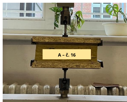
Obr. č. 21 - Upevnění zkušebního vzorku do zkušebního lisu pro stanovení pevnosti v tahu
