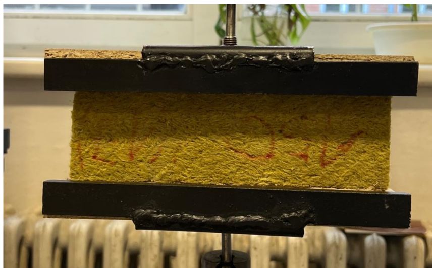
Obr. č. 27 - Upevnění zkušební vzorku do zkušební lisu pro stanovení pevnosti v tahu
