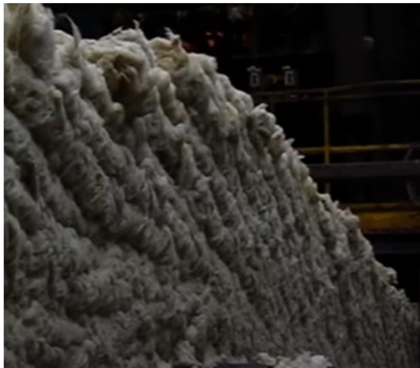
Obr. č. 6 – Vytvořený koberec po vrstvení minerální za pomoci „pendlovacího zařízení“ [61]
