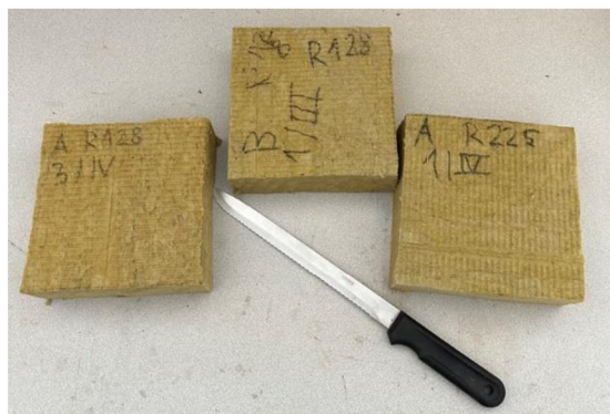
Obr. č. 16 – Naformátovaná zkušební tělesa o rozměru 200 \times 200 mm
