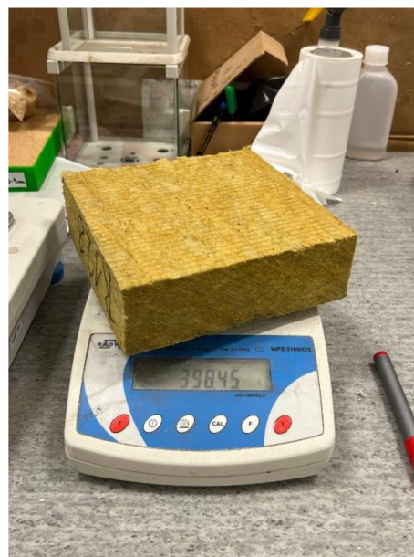
Obr. č. 18 - Měření hmotnosti m na laboratorních vahách
