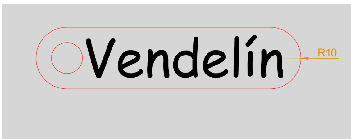
Obrázek 22: Závěrečné zaoblení klíčenky
