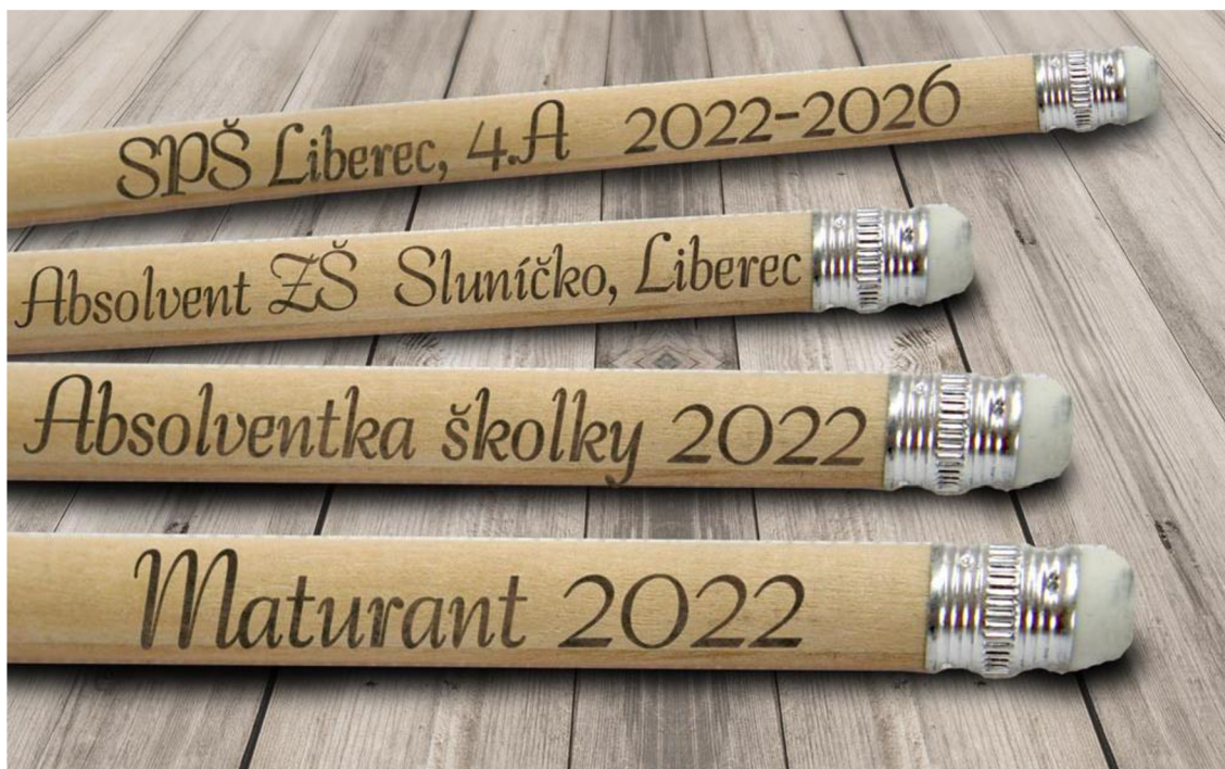
Obrázek 6: Popis tužek pomocí CO 2 laseru
