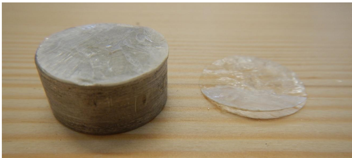
Obrázek č. 14 – plošné oddělení perleťového vzorku (zdroj:autor)
