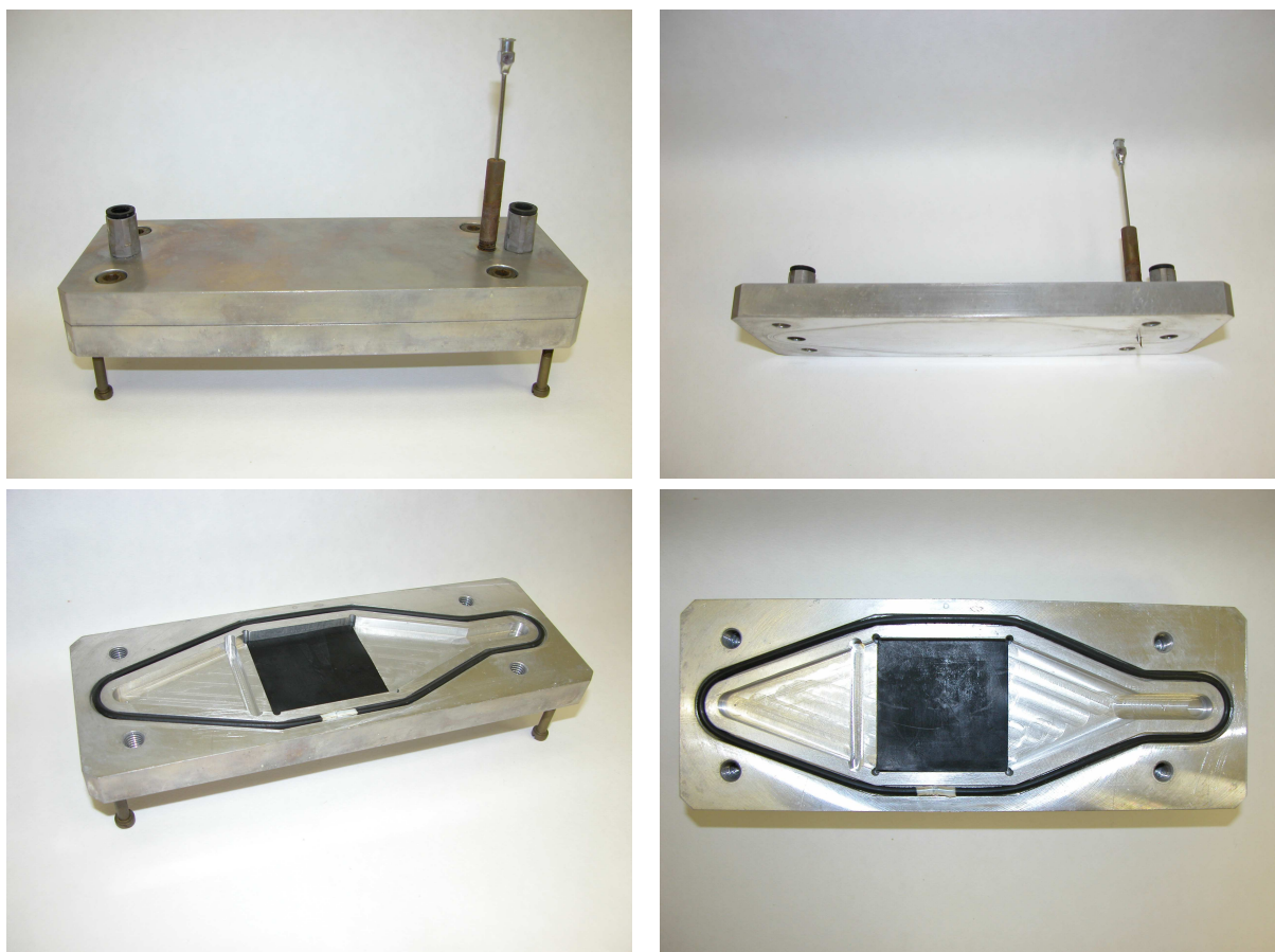
Obrázek 21 Fotografie extrakční cely. Vlevo nahoře: celkový pohled, vpravo nahoře: horní díl, vlevo a vpravo dole: spodní díl s pryžovým vzorkem
