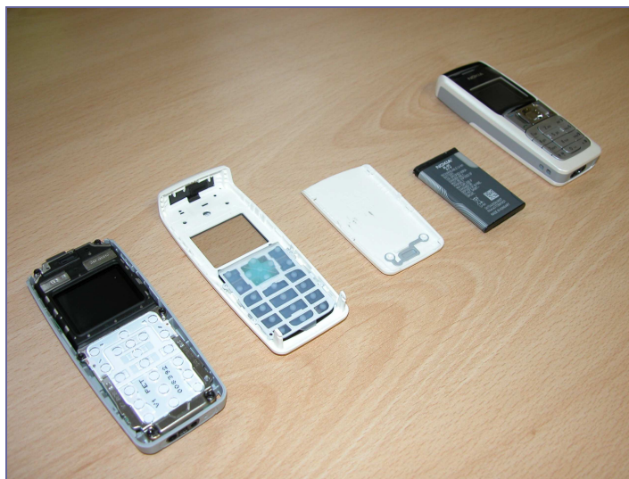
Obrázek 50 Ilustrace mobilního telefonu Nokia 2310 použitého jakožto modelová komponenta spojovací techniky
