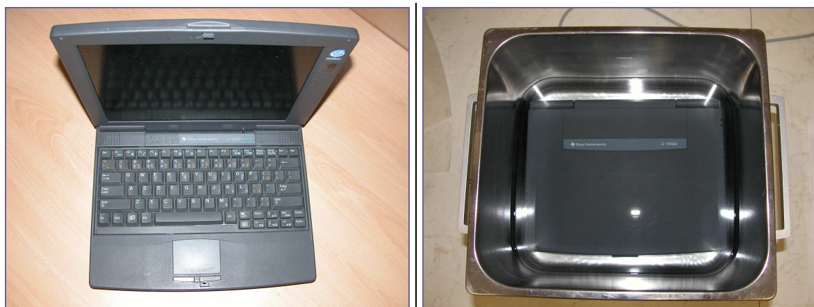
Obrázek 54 Ilustrace notebooku použitého pro zkoušky jakožto zástupce výpočetní techniky, (vlevo) notebook před zkouškami, (vpravo) notebook ponořen v rozpouštědle HFE-7200
