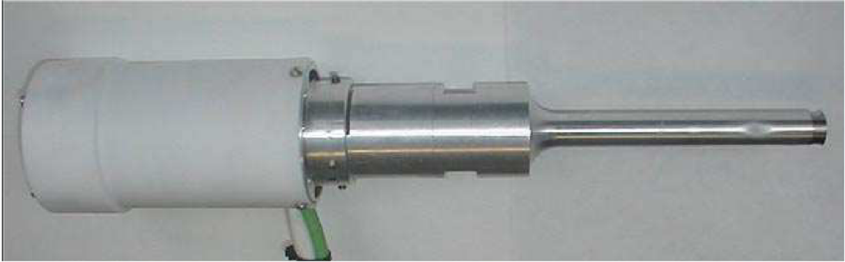
Obrázek 17 Příklad sonifikátoru se stupňovitým vlnovodem [57]
