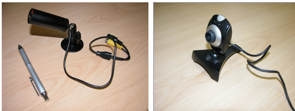
Obrázek 52 Ilustrace LCD kamer použitých jakožto modelová komponenta optické techniky, vlevo: OV910, vpravo: Trust I4823
