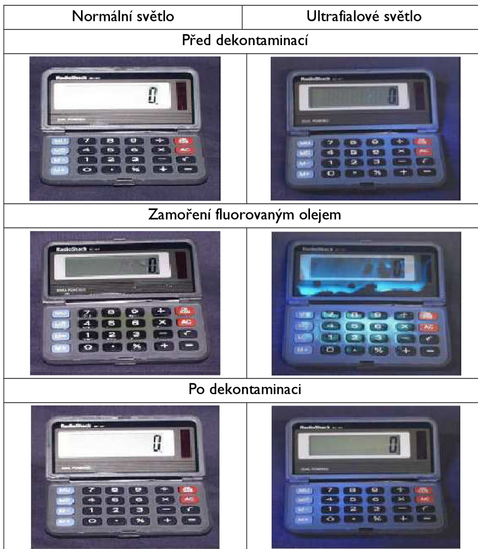
Obrázek 2 Fotografie kalkulátoru v průběhu extrakční dekontaminace [26]
