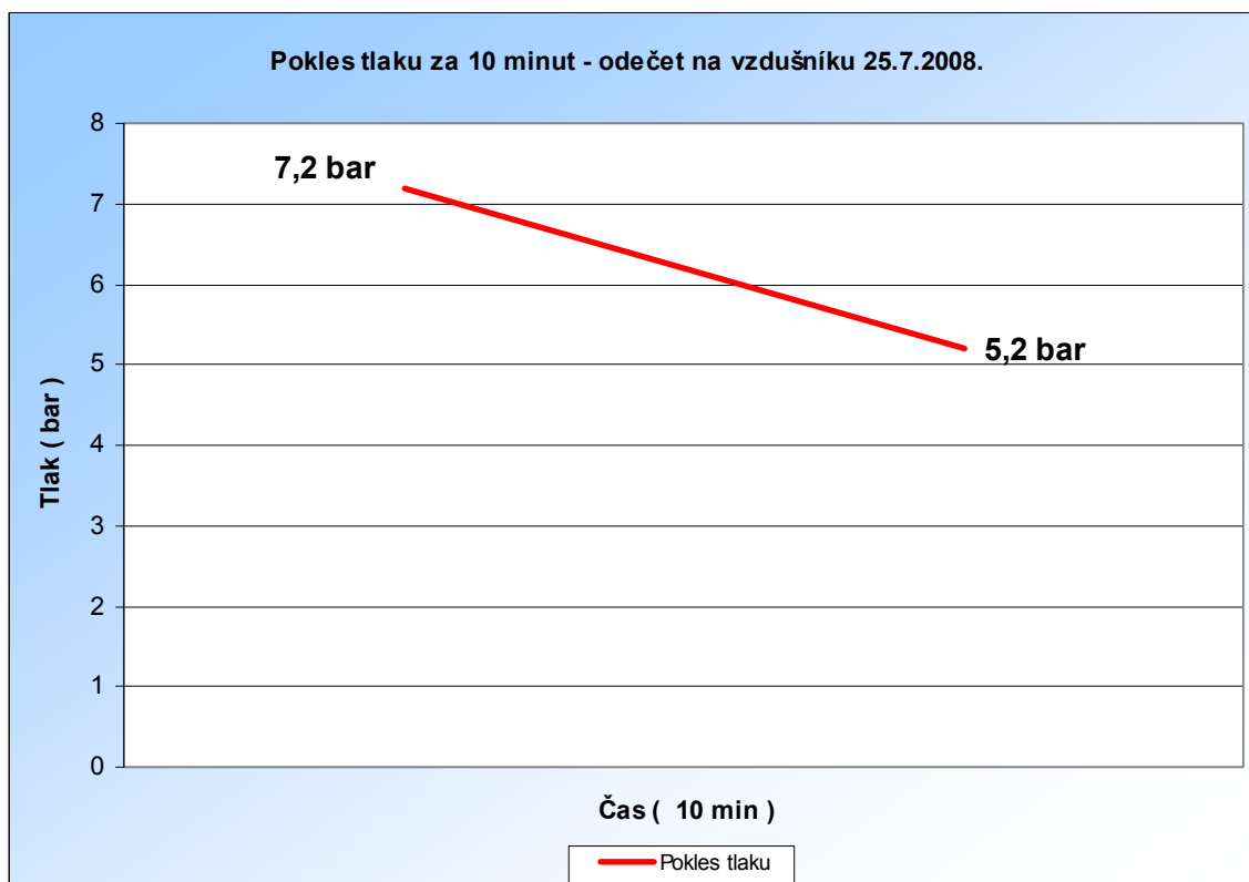
Obr. 4.9 Měření úniků stlačeného vzduchu (autor)
