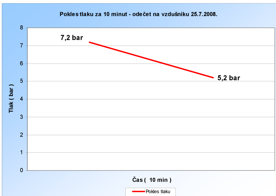
Obr. 4.9 Měření úniků stlačeného vzduchu (autor)
