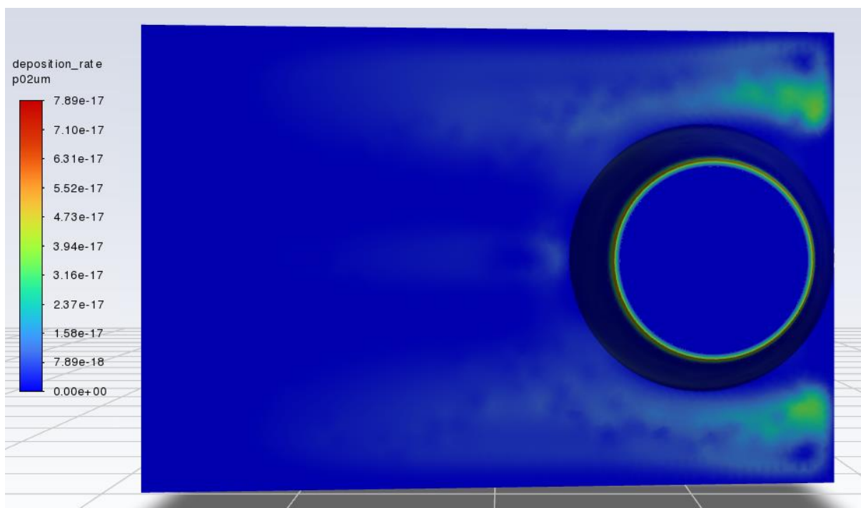
Obr. 17 – Zanášení spodní části usazovací komory částicemi o průměru 0,2 μm
