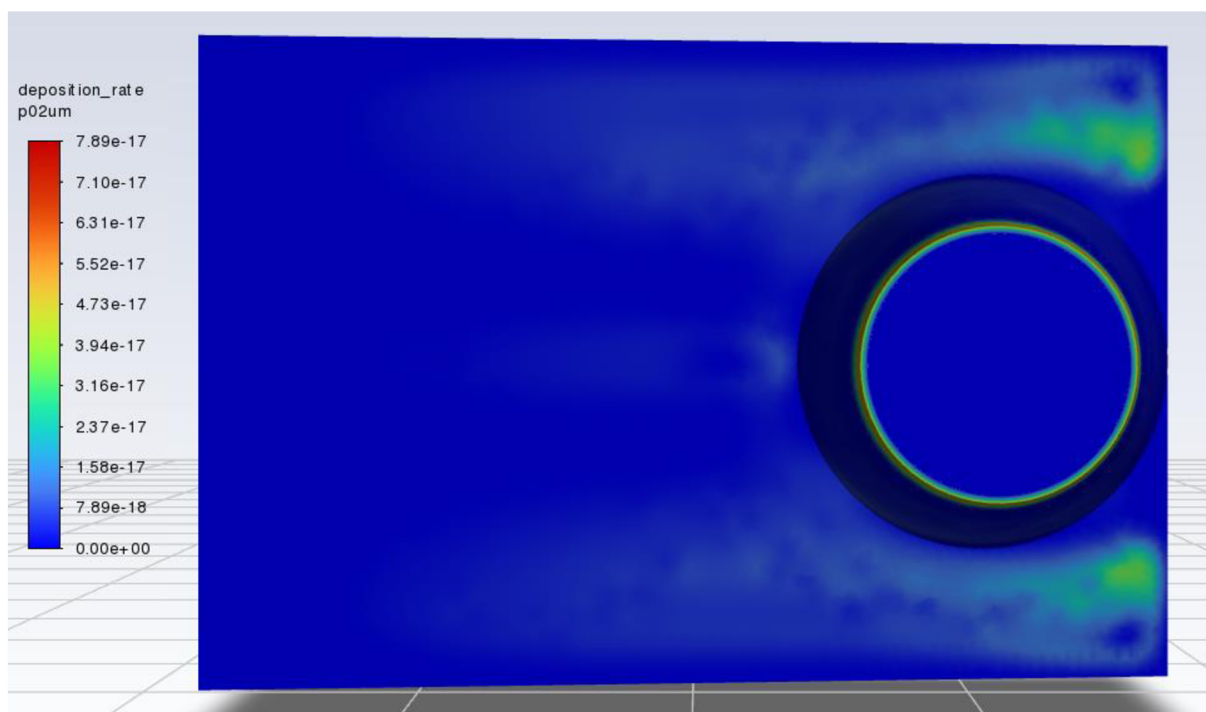
Obr. 17 – Zanášení spodní části usazovací komory částicemi o průměru 0,2 \mu\text{m}
