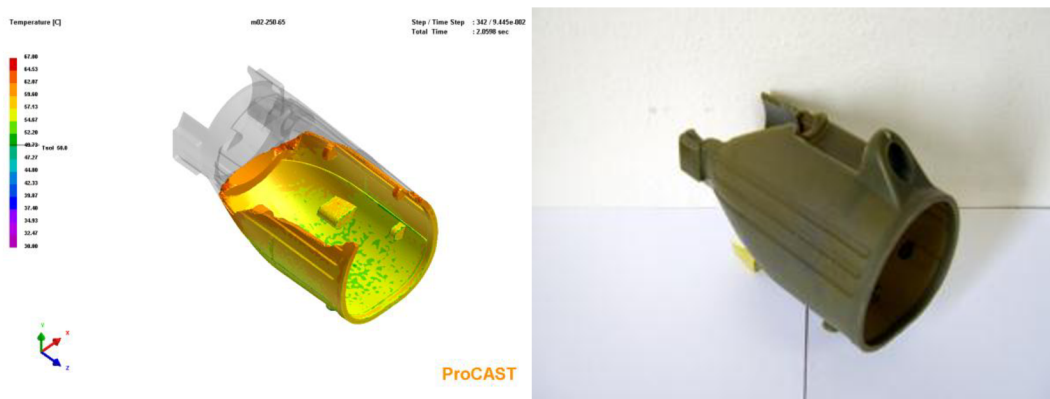
Obr. 11.4: Porovnání numerické simulace ( COLDSHUT 1 ) a skutečného plnění pro Variantu B
