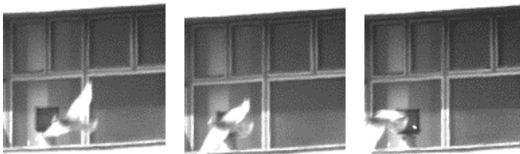
Obr. 1.11. Přerušování svazku způsobené průletem ptáka optickým svazkem
