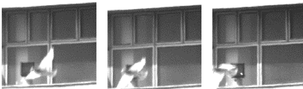
Obr. 1.11. Přerušování svazku způsobené průletem ptáka optickým svazkem
