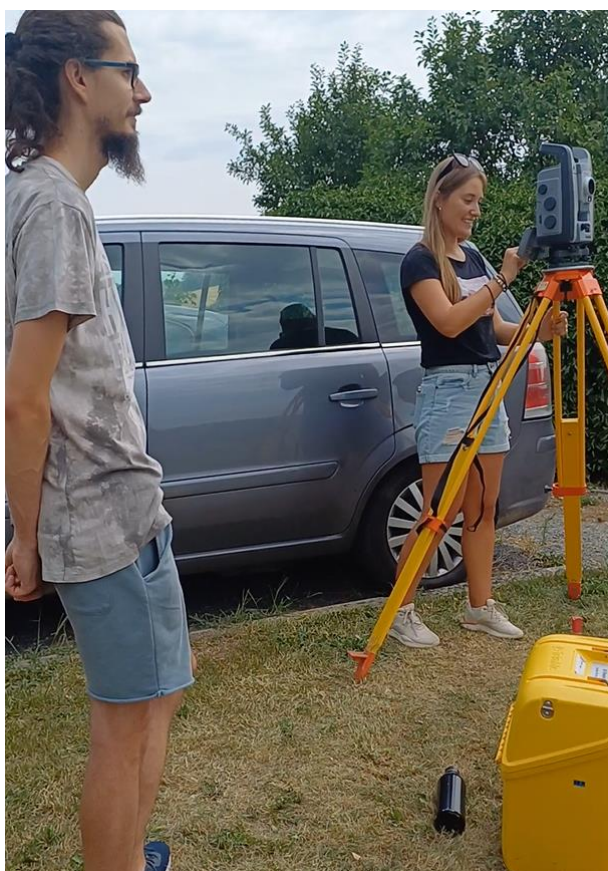
Obr. 14: Zaměření VB v terénu pomocí totální stanice Trimble S8 [zdroj: vlastní foto]
