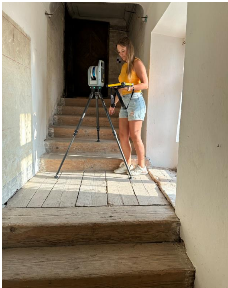
Obr. 37: Skenování schodiště vedoucího na půdu [zdroj: vlastní foto]
