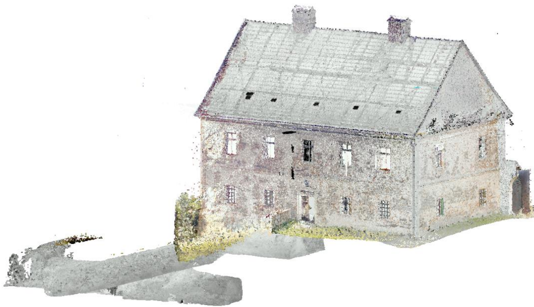
Obr. 24: Mračno bodů importované do Revitu [zdroj: vlastní]
