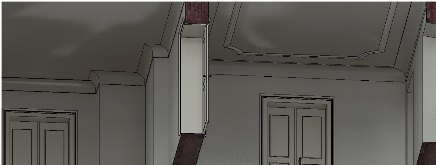
Obr. 43: Fabiony a zrcadla vymodelovaná v Revitu [zdroj: vlastní]
