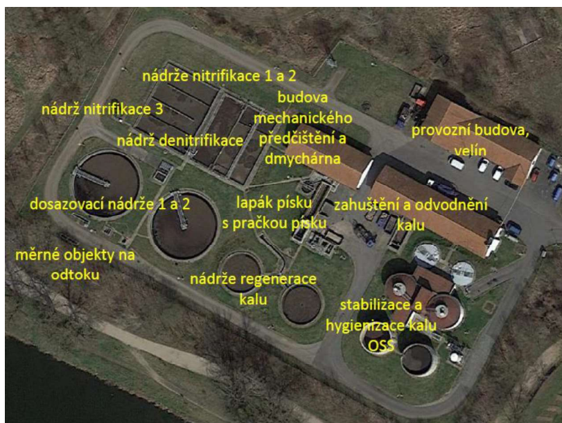
Obrázek č. 6: Dispozice stávající ČOV 20 000 EO
