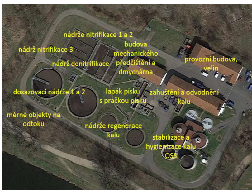
Obrázek č. 6: Dispozice stávající ČOV 20 000 EO
