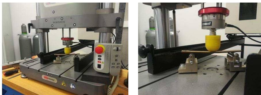
Obrázek 2.19: Cyklické zatěžování, pro určení velikosti útlumu
