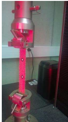
Obrázek 2.3: Tahová zkouška jutové tkaniny
