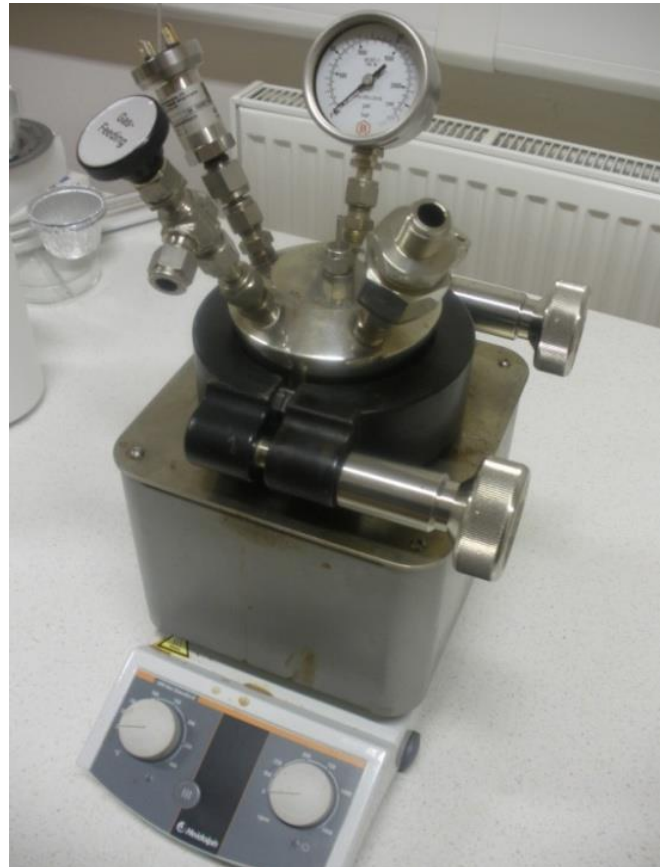
Obr. 7 Karbonizační aparatura: Reaktor je usazen na ohřivači uvnitř izolátoru.
