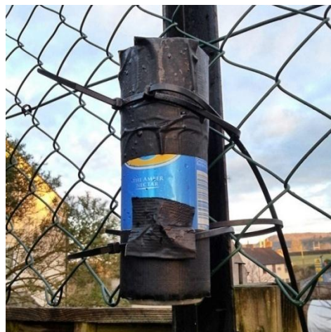
Obr. 17: Pinhole camera vyrobená z plechovky od piva Matta Bigwooda.
