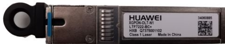
Obr. 7.8: Fotografie SFP+ modulu použitého v OLT
