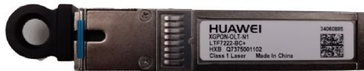
Obr. 7.8: Fotografie SFP+ modulu použitého v OLT
