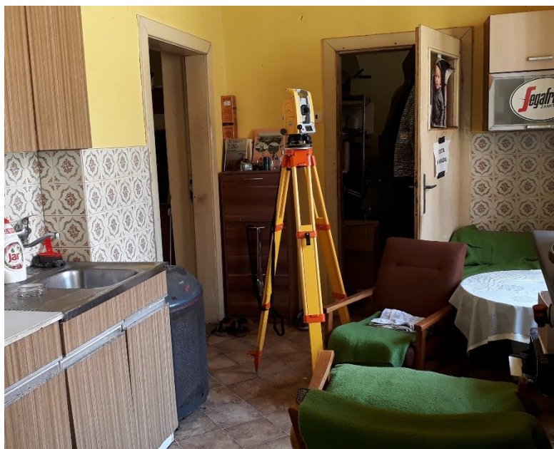
Obr. 5.4 – Měření totální stanicí (Foto K. Velecká)
