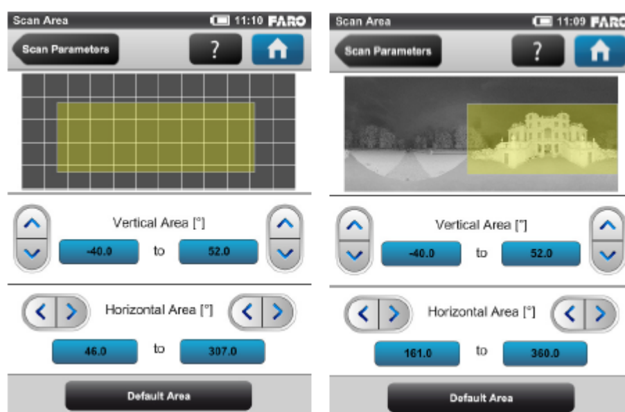
Obr. 5.17 – Nastavení rozsahu skenovaného objektu [8]
