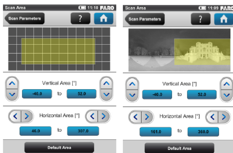
Obr. 5.17 – Nastavení rozsahu skenovaného objektu [8]
