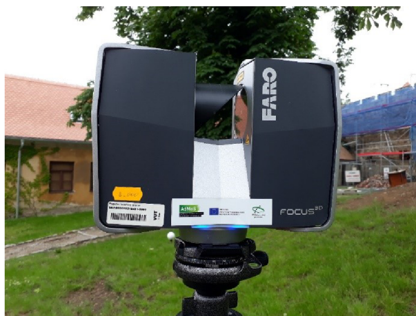
Obr. 5.2 – Laserový skener Faro Focus 3D (Foto K. Velecká)
