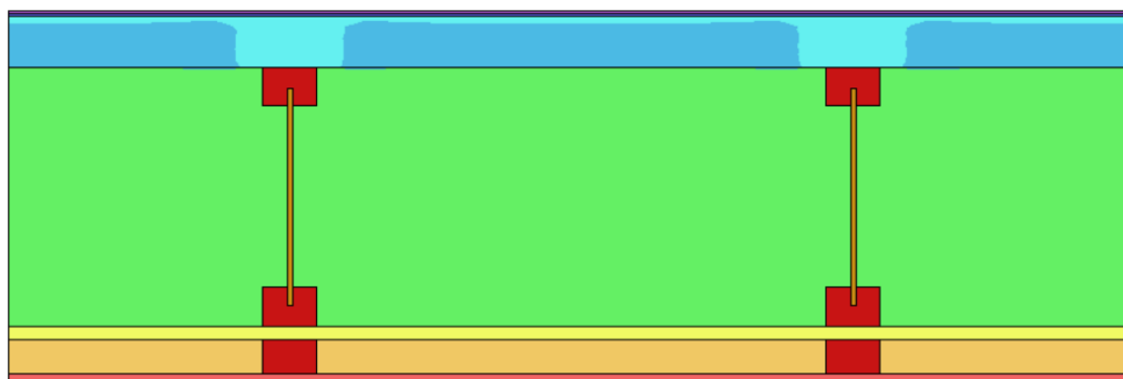
Obrázek 55 Oblast kondenzace uvnitř konstrukce při ponížení \mu OSB desky na 70 % – 2D výpočet.
