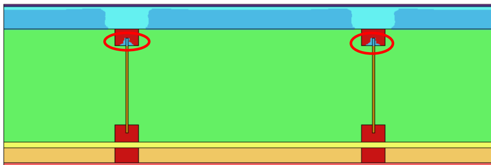
Obrázek 54 Oblasť kondenzace uvnitř konstrukce při ponížení \mu OSB desky na 50 % – 2D výpočet.
