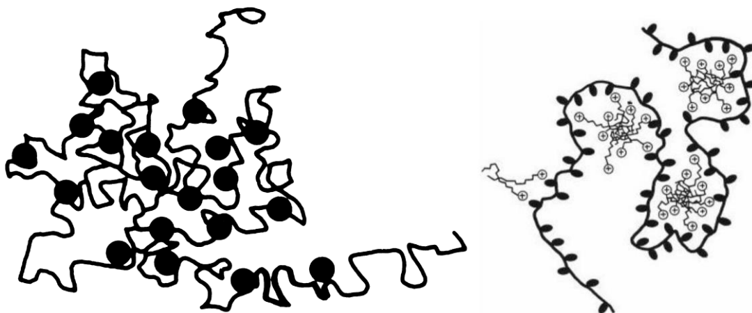
Obrázek 8 Vlevo je model náhrdelníku (Khan et al. 2008) vpravo je zobrazeno působení iontových částí surfaktantu na polymerní řetězec (Abuin 1984)
