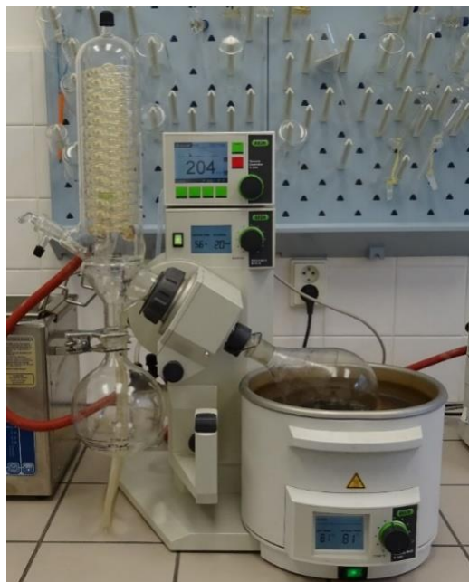
Obrázek 9: Rotační odparka BÜCHI R-215 (Autor práce 2019)
