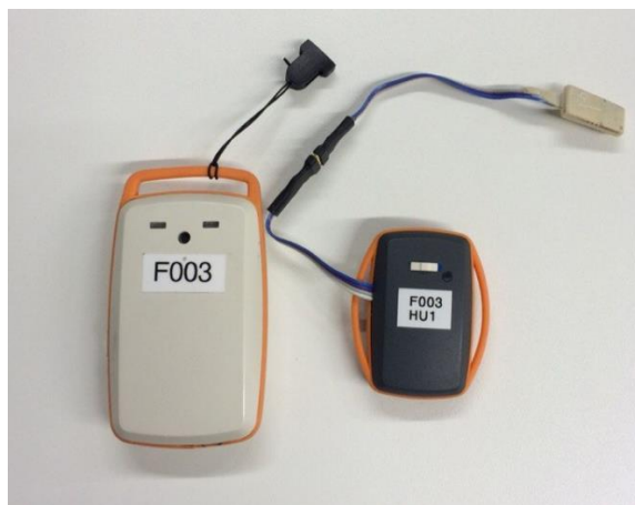
Obr. 17 Bezdrátová monitorovací jednotka
