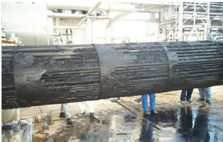
Obr. 8: Ukázka tvorby usazenin v místech s nižší rychlostí za přepážkami výměníku[12]
