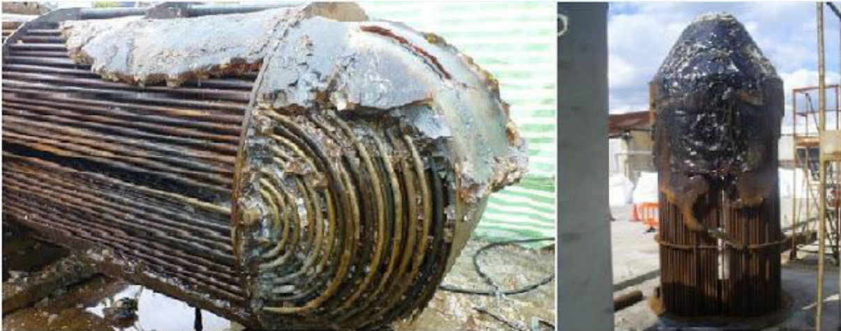
Obr. 20: Ukázka výměníku postiženého chemickým zanášením[25]
